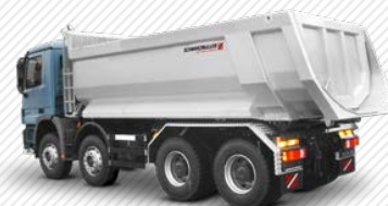
Muldenkipppaufbau auf 4-Achs-LKW. Optional Stahl- oder Alu-Mulde möglich. Varianten: 2-, 3-, 5-Achs-LKW
