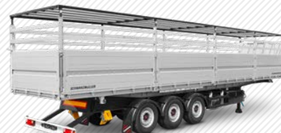
3-Achs-3-Seiten-Fernerkehr-Kippsattel mit Verdeck und Plane. Variante: 2-Achser
