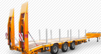
3-Achs-Tiefladesattel mit Kröpfung und teleskopierbarem Rahmen. Ausziehlänge bis zu 6 m.
