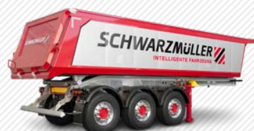
3-Achs-Thermo-Alu-Kastenmulde. Optional mit Alu- oder Stahl Fahrgestell. Variante: 2-Achser
