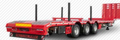
3-Achs-Tele-Mega Baustoffsattel. Optional mit teleskopierbarem Zentralrahmen bis 4 m. Variante: 2-Achser
