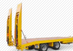
Zentralachs oder Tandem Tiefladeanhänger mit Auffahrampen. Variante: 3-Achser
