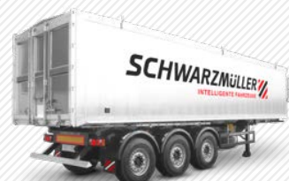
3-Achs-Alu-Großraummulde. Optional mit Alu- oder Stahl Fahrgestell. Variante: 2-Achser
