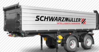
2-Achs-3-Seiten-Kippsattel mit großem Radstand und 2 x 10 t Achsen. Varianten: 2 x 9 t Achsen und kurzer Radstand, 3-Achs-3-Seiten-Kippsattel
