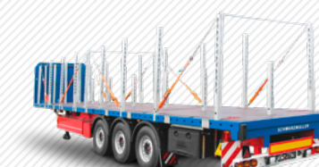
3-Achs-Baustoffsattelanhänger mit spezieller Ausstattung für den Baustahlmattentransport. Variante: 2-Achser
