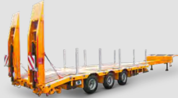
3-Achs-Tiefladesattel mit Kröpfung und teleskopierbarem Rahmen
