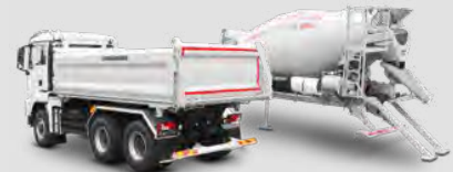
Wechselsystem Kippaufbau und Betonmischer
