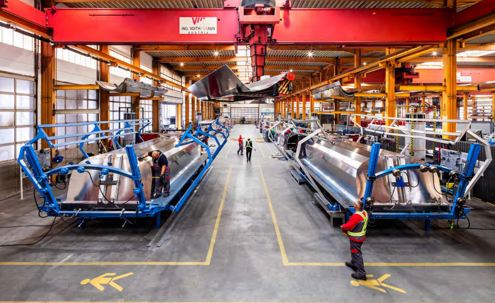
Alu-Segmentmulden sind spezielle Leichtbaufahrzeuge für die Bauwirtschaft, die im ungarischen Werk hergestellt werden.
