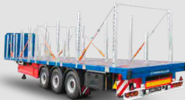
3-Achs-Baustoff-Sattelanhänger mit spezieller Ausstattung für den Baustahlmattentransport
