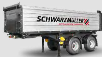
2-Achs-3-Seiten-Kippsattel mit großem Radstand und 2 x 10 t Achsen
