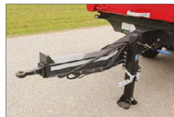
Zugstange gekröpft mit höhenverstellbarer Öse (Zentralachs-Kippanhänger)
