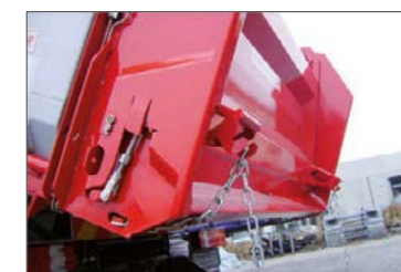
Haken an der Rückwand zum einhängen der Dosierketten
