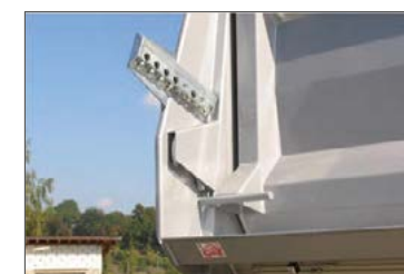
Dosiereinrichtung für Pendel-Rückwand mit Vorsteckbolzen
