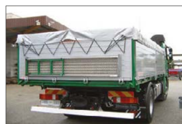
Heckseitig ein klappbares Stehpodest
