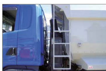
Aluminium-Aufstiegleiter vorne an der Mulde
