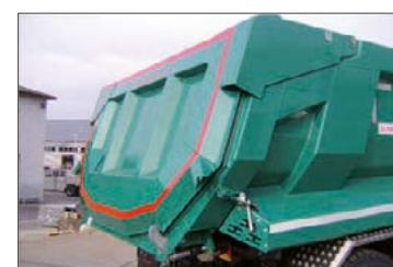
Außenliegende und schlammdichte Rückwand
