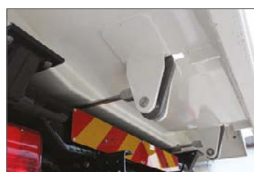
Automatische, mechanische Rückwandverriegelung
