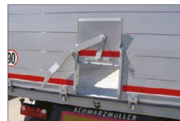
Heckseitig in der Rückwand mit Getreideschuber
