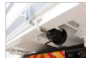
Pneum. Rückwand-Verriegelung vom Fahrerhaus zu öffnen
