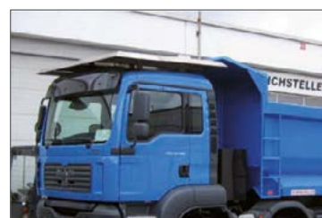
Vorne oben mit Abdeckung für das Fahrerhaus
