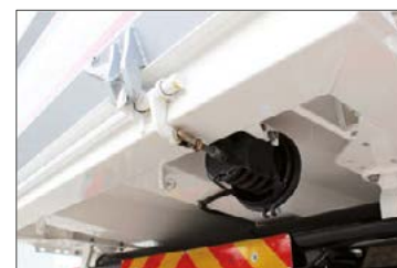
Pneum. Rückwand-Verriegelung vom Fahrerhaus zu öffnen
