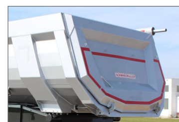
Außenliegende Rückwand – dadurch mehr Ladevolumen
