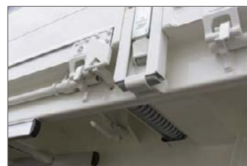
Unterflur-Hebehilfe zum leichteren abklappen der Bordwände
