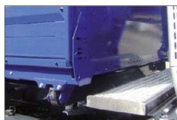
Stehpodest vorne zwischen Kipperbrücke und Fahrerhaus
