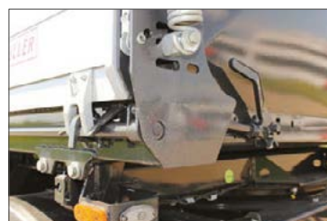
Mechanische Zentralverriegelung der Seitenwände
