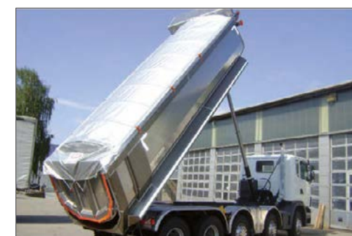
Schieberverdeck, mit 300 mm Bogenhöhe, wahlweise manuelle oder elektrische Betätigung, samt Kunststoff-Plane und beidseitig Verriegelungshaken, sowie hinten Zick-Zack-Verschnürung
