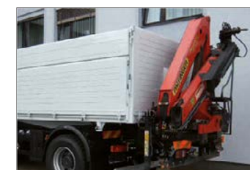
Fernverkehrs-Kippaufbau mit Heckkran
