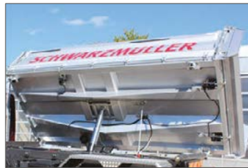
Kipperbrücke in Hohlkammer-Bauweise
