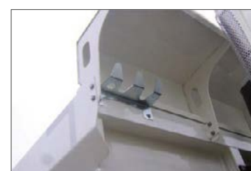
Schaufel- und Besenhalterung vorne an der Mulde
