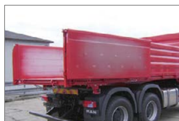
Rückwand zusätzlich als Türflügel ausschwenkbar
