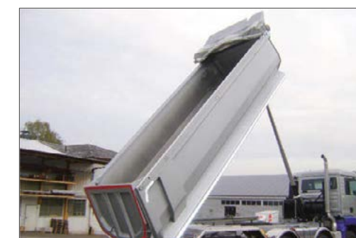
Schieberverdeck, mit 300 mm Bogenhöhe, wahlweise manuelle oder elektrische Betätigung, samt Kunststoff-Plane und beidseitig Verriegelungshaken, sowie hinten Zick-Zack-Verschnürung
