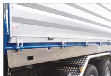
Aluminium-Schüttleiste auf Zentralverriegelungswelle
