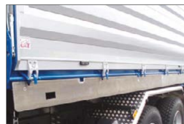
Aluminium-Schüttleiste auf Zentralverriegelungswelle
