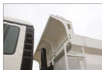
Vorderwand oben mit erhöhtem Baggerschutz, sowie mit Aufstiegleiter
