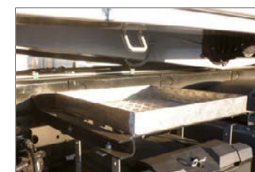
Aluminium-Ablagewanne seitlich unter der Kipperbrücke
