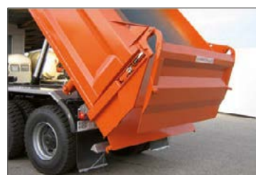
Hydraulische Rückwandklappe, mittels doppelwirkendem Zylinder
