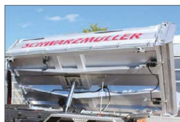
Kipperbrücke in Hohlkammer-Bauweise
