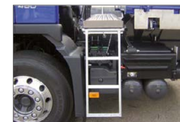
Ausziehbare Aufstiegleiter vorne zwischen Brücke und Fahrerhaus
