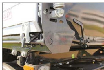
Mechanische Zentralverriegelung der Seitenwände
