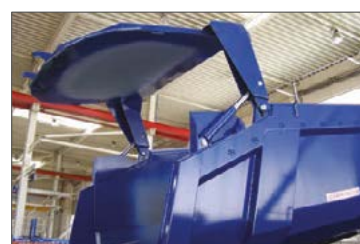
Sonder-Pendelrückwand für extrahohe Öffnung mit autom. Hydraulikbetätigung
