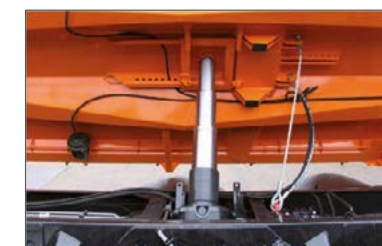
Kardanische Mittelpresse für 3-Seiten-Kippung
