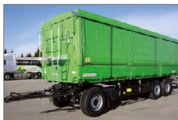
Fernverkehrs-Kippanhänger mit Rolldach und Seitenplanen
