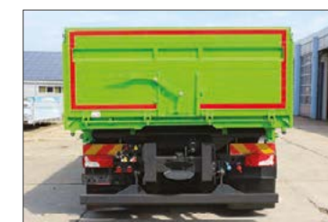
Aluminium-Hohlprofil-Rückwand, mit Getreideschuber ca. 400/400 mm
