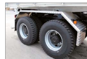
Hinterradabdeckung mit durchgehende Alu-Riffelblech-Kotflügel
