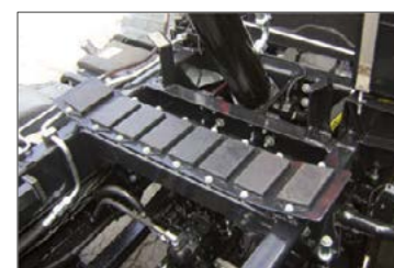
Gummiauflagen für ein sauberes und exaktes Aufliegen der Mulde
