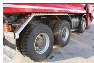
Hinterradabdeckung mit durchgehende Alu-Riffelblech-Kotflügel
