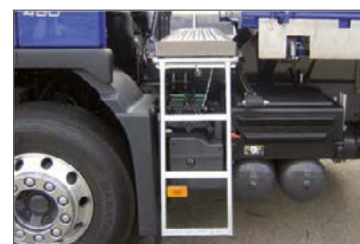
Kihúzható fellépő elől a puttony és a vezetőfülke között
