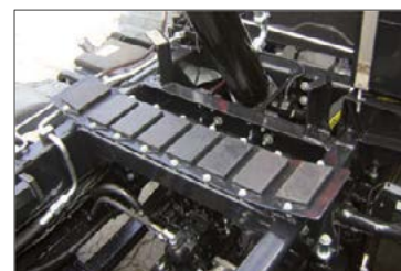
Gumialátétek a puttony stabil fekvése érdekében
