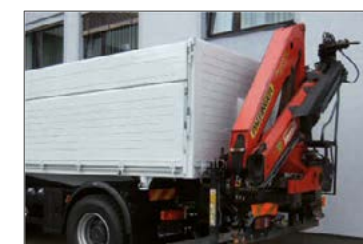
Gabonás kivitelű felépítmény fardaruval
