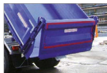
Pneumatikus működtetésű hátsó ajtó
