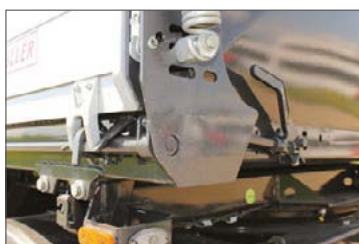
Mechanikus, központi ajtózárs az oldalfalnál
