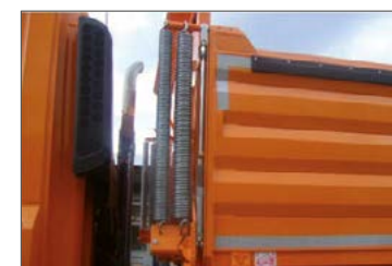
Erősített, dupla rugós emelésrészegítő az oldalfalhoz
