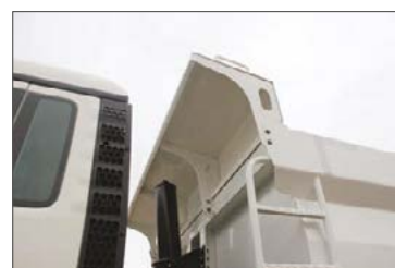
Mellfal magasított fülkevédővel, létrával
