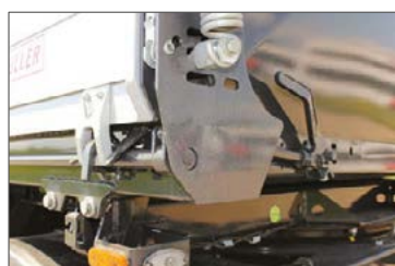
Mechanikus, központi ajtózárs az oldalfalnál
