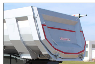
Kívülre záródó hátsó ajtó - ezáltal nagyobb raktérfogat
