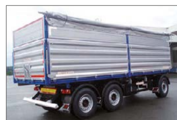
Építőipari billenő pótkocsi feltekerhető ponyvával és ajtómagasítással
