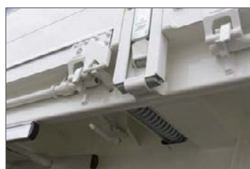
Emeléssegély a puttony alatt az oldalajtók könnyebb lenyithatóságához
