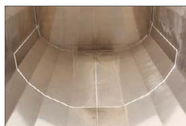
Alumínium koptatólemez a puttony hátsó részén
