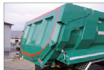
Kívülre záródó hátsó ajtó, tömítéssel
