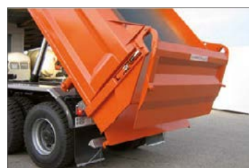
Hidraulikusan működtetett hátsó ajtó, kettős működésű munkahengerrel
