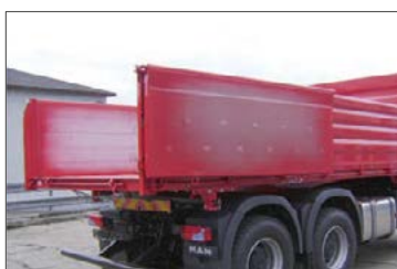
A hátsó ajtó oldalra is kifordítható
