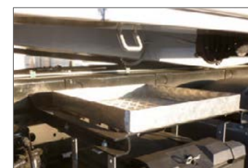
Alumínium csepptálca oldalt a puttony alatt
