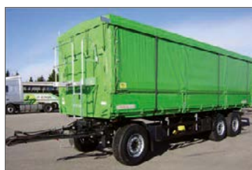
Gabonás billenő pótkocsi feltekerhető tetőponyvával és oldalponyvával
