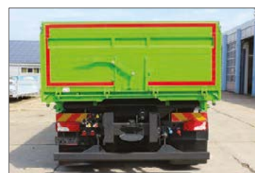
Hátsó ajtó üreges alumínium profilból, 400 x 400 mm-es gabonaablakkal
