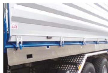
Alumínium terelőlemez a zártengelyen
