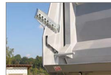
Adagolóberendezés lengő kivitelű hátsó ajtóhoz, rögzítőcsappal
