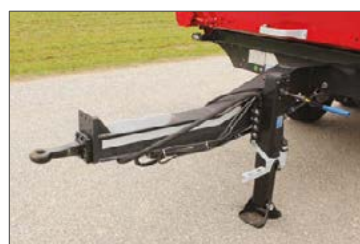
Tört vonórúd állítható magasságú vonószemmel (tandem billenő pótkocsi)
