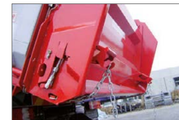
Kampó a hátsó ajtón az adagoló-láncnak
