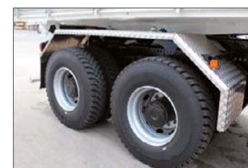
Cseppmintás alumínium lemez sárvédő a hátsó kerekek felett
