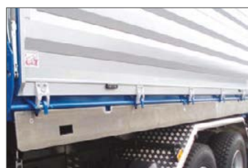
Alumínium terelőlemez a zártengelyen
