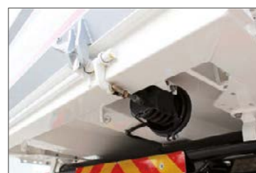
Pneumatikus zárszerkezet a hátsó ajtóhoz (a vezetőfülkéből működtethető)
