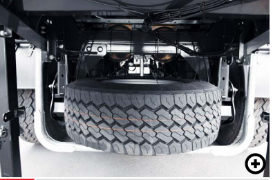
R Uchwyt koła zapasowego Umożliwia bezproblemowe przewożenie koła zapasowego.
