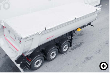
M Zwijana plandeka Zwijana plandeka chroni przewożony ładunek przed stratą materiałową i wpływem warunków atmosferycznych. Plandeka zwijana i rozwijana jest z podestu i zabezpieczana za pomocą pasów i szybkomontażowych napinaczy.
