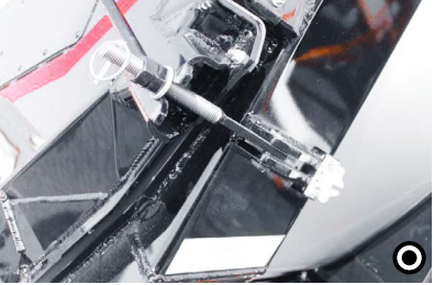
K Śruby mocujące Gęsty, płynny materiał zwiększa nacisk na tylną kłapę. Aby kłapa wytrzymała takie obciążenie, jako zabezpieczenie montowane są dodatkowe śruby mocujące.
