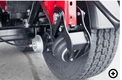
V Podnoszona oś Podnoszone osie zmniejszają zużycie opon. Podczas przejazdu pustych pojazdów, osie, które nie są w danej chwili potrzebne, są automatycznie podnoszone.
