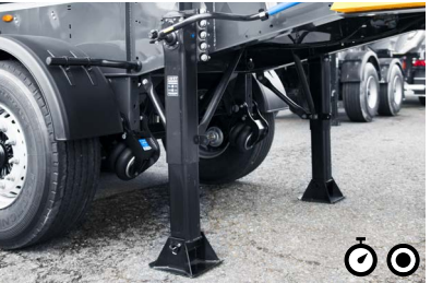
U Podpory Firma Schwarzmüller oferuje różnego rodzaju podpory: w wersji korbowej ze stali lub aluminium albo w wersji składanej ze stali lub aluminium.
