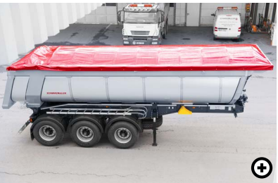
N Dach Schwarzmüller Elektrycznie przesuwany dach z pilotem do otwierania i zamykania ochronnej plandeki bez konieczności wchodzenia na podest.
