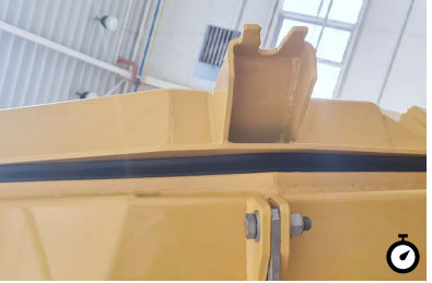
L Gumowa uszczelka Dodatkowe gumowe uszczelki w tylnej kłapie gwarantują odpowiednią szczelność muldy.
