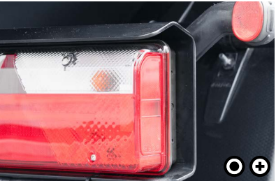
T Osłona światła Światło tylne posiada blaszaną osłonę chroniącą je w możliwie najlepszy sposób przed uszkodzeniem i większymi zabrudzeniami.
