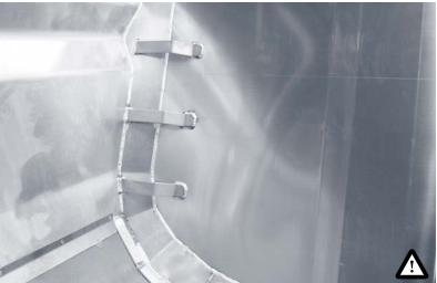
11 Aufstieg Mulde innen An der inneren Stirnwand der Segmentmulde sind mehrere, stabile Auftritte verschweißt. Dies ermöglicht ein problemloses und sicheres Ein- und Aussteigen.
