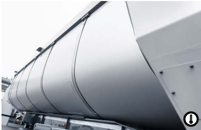
7 Thermomulde Die Mulde ist zur Gänze thermisch isoliert. Asphalt-Mischgut kann so mit höheren Temperaturen an die Baustelle gebracht werden, was die Einbauqualität erheblich steigert.
