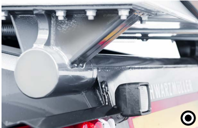
4 Einteilige Kipperwelle Die Kipperwelle wird nicht nur seitlich, sondern durchgehend angeschweißt. Durch diese Bauart erreicht man mehr Stabilität während des Kippvorgangs.
