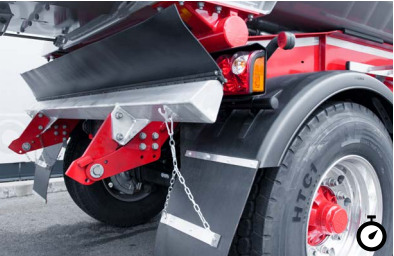
8 Klappbarer Unterfahrschutz Der Unterfahrschutz wird standardmäßig hochklappbar ausgeführt, damit bei einer Fertigerbeschilderung stets die nötige Bodenfreiheit gewährleistet ist.
