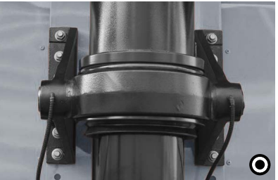
12 Vier-Punkt-Lagerung Die Kipperpresse ist an vier Positionen (je zwei Mal oben und unten) gelagert. Das schafft eine einzigartige Kippstabilität gegenüber einer Drei-Punkt-Lagerung.
