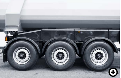
9 Einzelradkotflügel Schwarzmüller Kippsattel verfügen über Einzelradkotflügel. Das schützt andere Verkehrsteilnehmer, aber auch die Mulde vor Steinschlägen und Verschmutzung.
