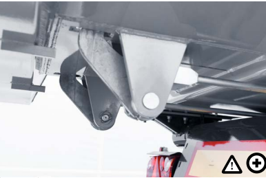
6 A hátsó ajtó reteszelésének automatikus kioldása Egy speciális rúd segítségével a billentési folyamat kezdetekor a hátsó ajtó zárszerkezete automatikusan kiold. Leengedéskor a reteszelés is automatikusan történik.
