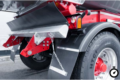
8 Felhajtható hátsó aláfutásgátló Alapkivitelben a hátsó aláfutásgátló felhajtható kivitelű, hogy finisherbe történő ürtéskor a szükséges szabad magasság biztosított legyen.
