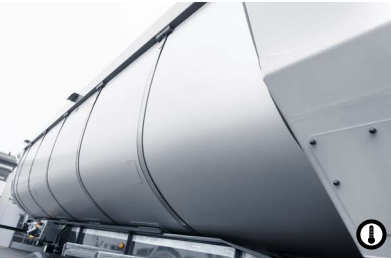
7 Hőszigetelt puttony A puttony teljes egészében hőszigetelt, így magasabb hőmérsékletű aszfaltkeverékeket lehet az építési helyszínre szállítani, ami jelentősen növeli az építési minőséget.
