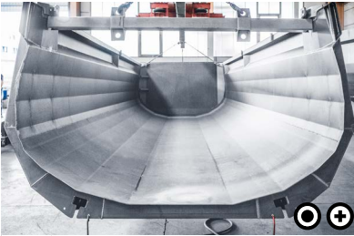
5 Acél puttony Az acél puttony 100%-ban tartós lemezből készül. A mell- és hátfal valamint a felső öv is ebből a kiváló minőségű anyagból készül.
