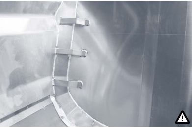
11 Létra a puttony belsejében A szegmentív puttony mellfalának belső oldalára több fix létrafok van hegesztve. Ezek segítségével könnyen fel és le lehet mászni.
