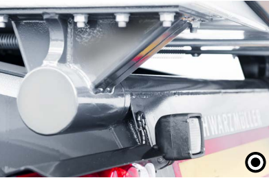
4 Egy darabból álló billenő tengely A billenő tengely nemcsak oldalról, hanem a teljes hossza mentén oda van hegesztve. Ennek a kialakításnak köszönhetően nagyobb stabilitás érhető el a billentési folyamat során.
