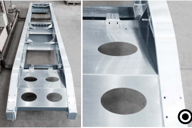
3 Párhuzamos alváz Szemben számos versenytárs járművével ennek a járműnek az egyik előnye a párhuzamosan vezetett két alváz-hossztartó. Ez minden helyzetben nagyobb stabilitást biztosít.
