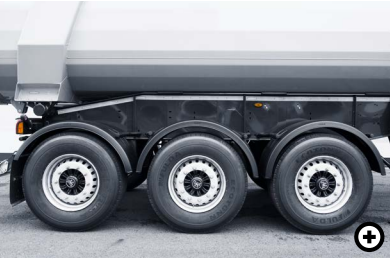
9 Sárvédő A Schwarzmüller billenős félpótkocsik minden egyes kereke sárvédővel van ellátva. Ez védelmet nyújt a közlekedés többi résztvevője számára, de a puttonyt is védi a felcsapódó követől és a szennyeződéstől.
