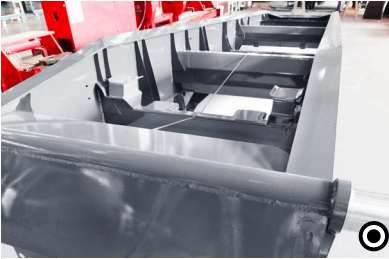
2 Torziós csövek Ezek a speciális keresztartók a torziósszekrényhez hasonlóan hozzájárulnak a billenős félpótkocsi stabilitásához a billentési folyamat teljes tartama alatt.
