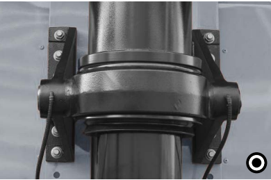
12 Négypontos csapágyazás A billentő munkahenger négy ponton (fent és lent két-két helyen) van alátámasztva. Ennek köszönhetően a jármű borulási stabilitása egyedülálló a hárompontos csapágyazáshoz képest.
