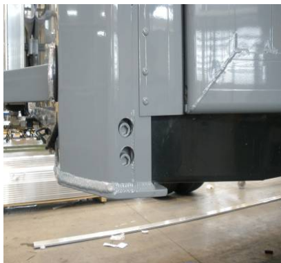
Säulen vorne: Schrauben auf Festsitz prüfen
