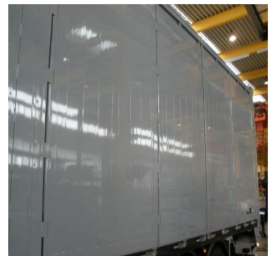
Türen an der Seitenwand: Scharniere auf ordnungsgemäße Funktion und Beschädigungen prüfen, Scharnierbefestigung auf Beschädigungen und Festsitz prüfen
