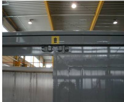
Drehstangenverschlüsse oben und unten: Schrauben auf Festsitz prüfen
