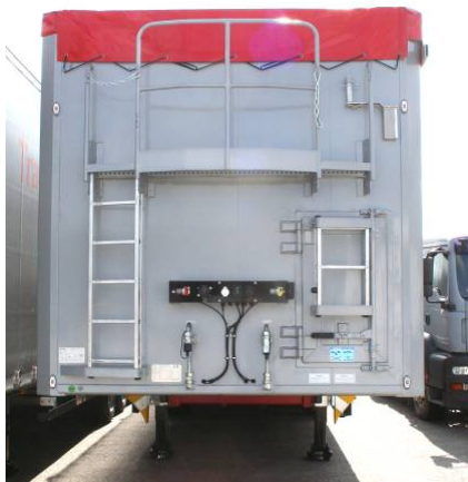
Alle Nieten und Schrauben auf Festsitz prüfen, Schweißnähte auf Risse prüfen
