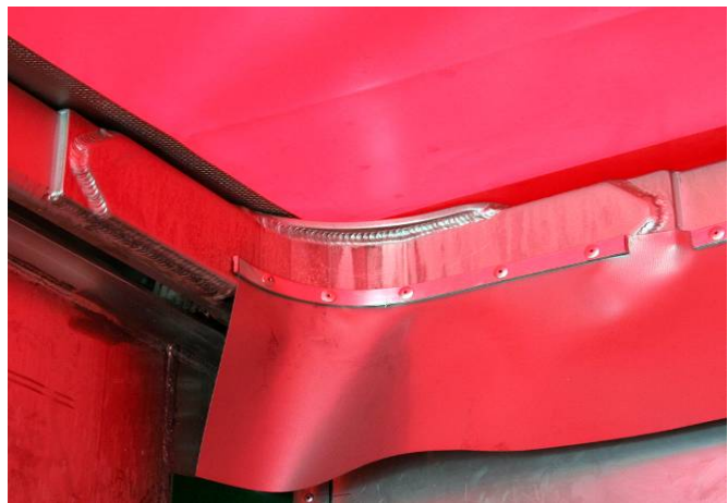
Vorderwand innen: Schweißnähte der Verstärkung zwischen Vorderwand und Seitenwand auf Risse prüfen
