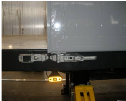
Drehstangenverschlüsse oben und unten: Schrauben auf Festsitz prüfen
