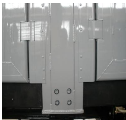
Mittelsäulen: Schrauben auf Festsitz prüfen
