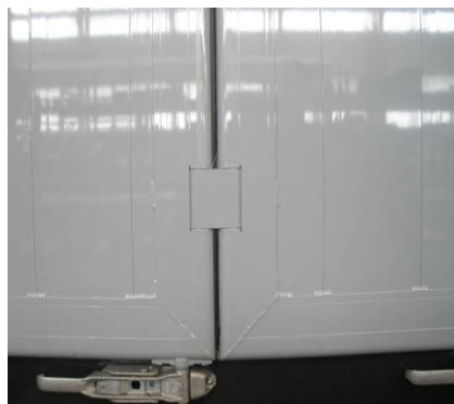
Türen an der Seitenwand: Scharniere auf ordnungsgemäße Funktion und Beschädigungen prüfen, Scharnierbefestigung auf Beschädigungen und Festsitz prüfen
