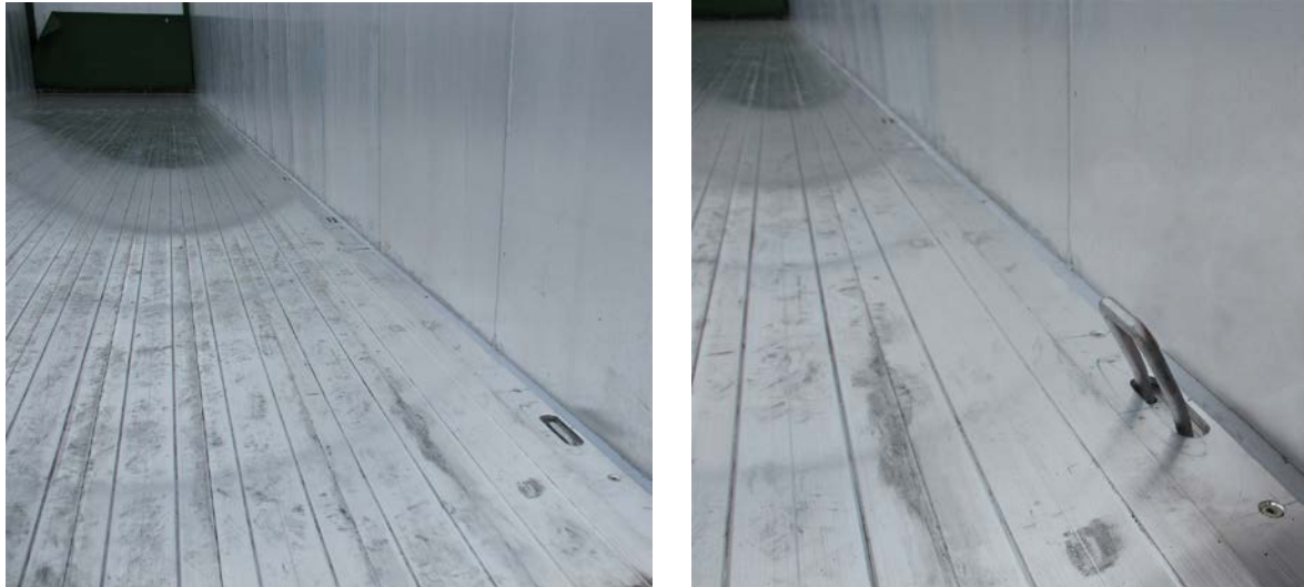
Zurrbügel seitlich neben Schubboden
