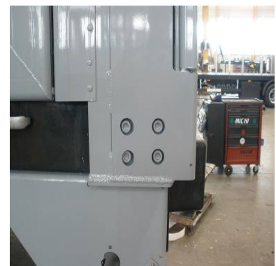
Säulen hinten: Schrauben auf Festsitz prüfen
