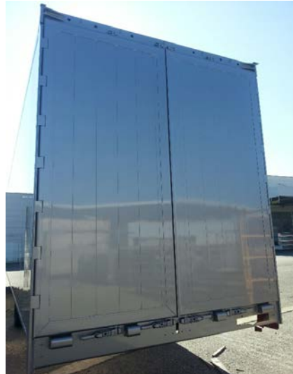
Schrauben auf Festsitz prüfen, Schweißnähte auf Risse prüfen
