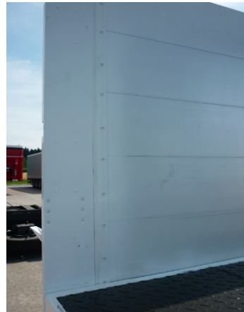
Bordwände: Nieten auf Festsitz prüfen
