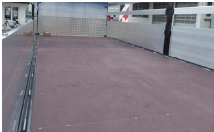
Verschiedenste Ausführungen von Zurrbügeln seitlich am Plateau
