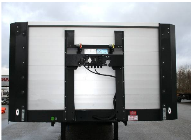
Alle Nieten und Schrauben auf Festsitz prüfen
