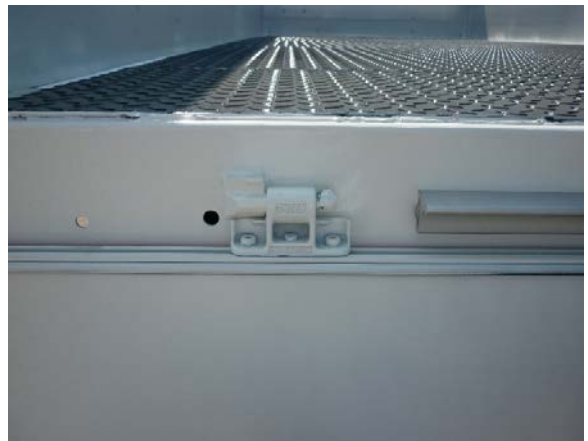
Scharniere auf ordnungsgemäße Funktion und Beschädigungen prüfen. Scharnierkegel: Schweißnähte auf Risse prüfen
