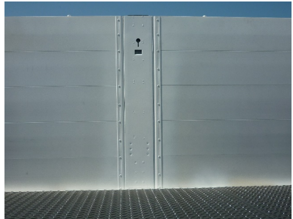
Bordwände: Nieten auf Festsitz prüfen
