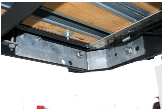
Verschraubung Ecksäule innen auf Festsitz prüfen
