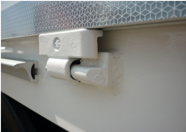
Scharniere auf ordnungsgemäße Funktion und Beschädigungen prüfen. Scharnierkegel: Schweißnähte auf Risse prüfen
