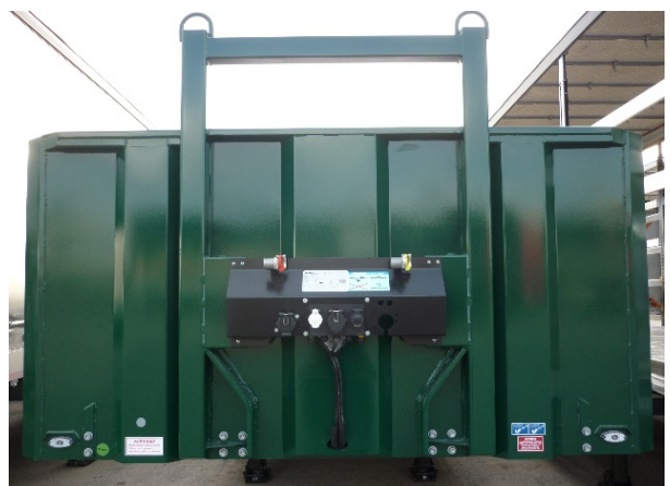
Verschraubungen auf Festsitz prüfen Schweißnähte auf Risse prüfen
