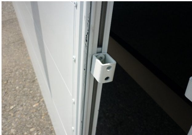
Gegenhalter auf Festsitz und Beschädigungen prüfen
