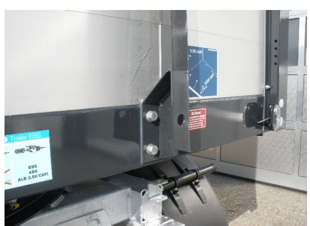
Verschraubung Vorderwandstütze auf Festsitz prüfen
