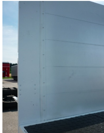
Bordwände: Nieten auf Festsitz prüfen
