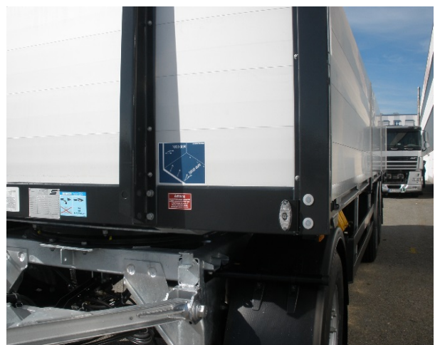
Gerätehalter: Alle Nieten und Schrauben auf Festsitz prüfen
