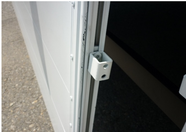
Gegenhalter auf Festsitz und Beschädigungen prüfen
