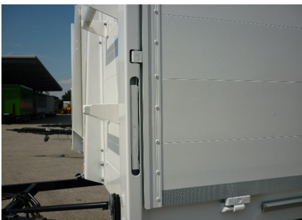
Verschraubung Ecksäule vorne auf Festsitz prüfen
