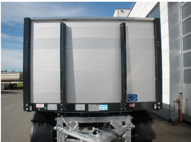
Alle Nieten und Schrauben auf Festsitz prüfen
