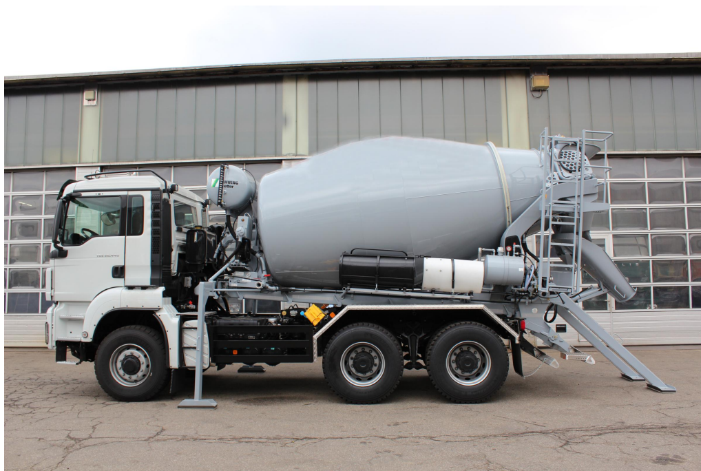
System szybkiej wymiany nadwozia wywrotki trójstronnej / betoniarki
