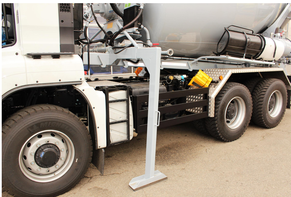
System szybkiej wymiany nadwozia wywrotki trójstronnej / betoniarki
