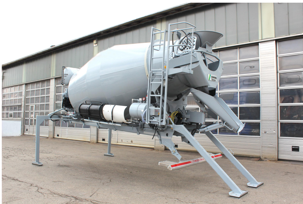
Podpory biegnące ukośnie do tyłu do bezpiecznego odstawienia nadwozia
