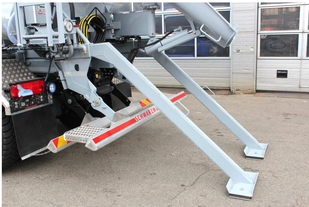
Podpory biegnące ukośnie do tyłu do bezpiecznego odstawienia nadwozia
