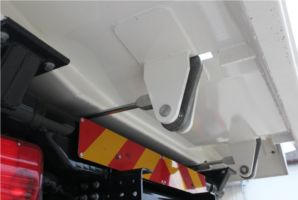
Automatyczna mechaniczna blokada ściany tylnej
