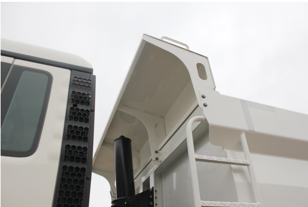
Ściana przednia na górze ze zwiększoną ochroną przed koparką
