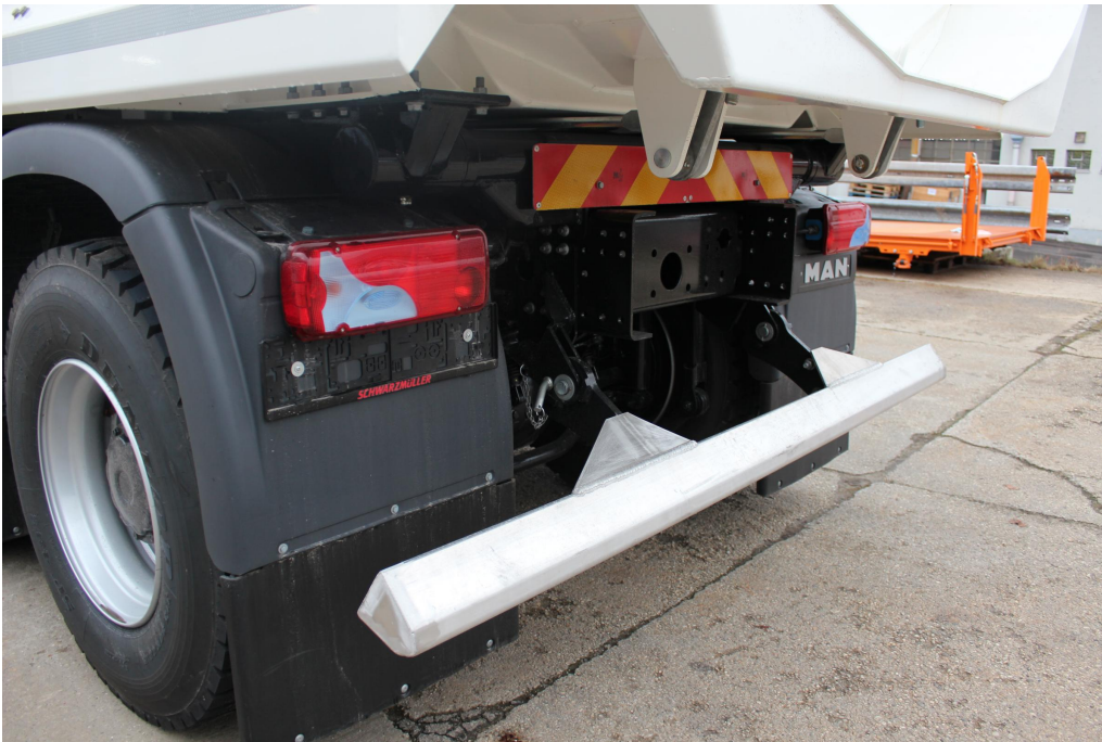
OPCJONALNIE: podnoszona aluminiowa osłona przeciwnajzdowa
