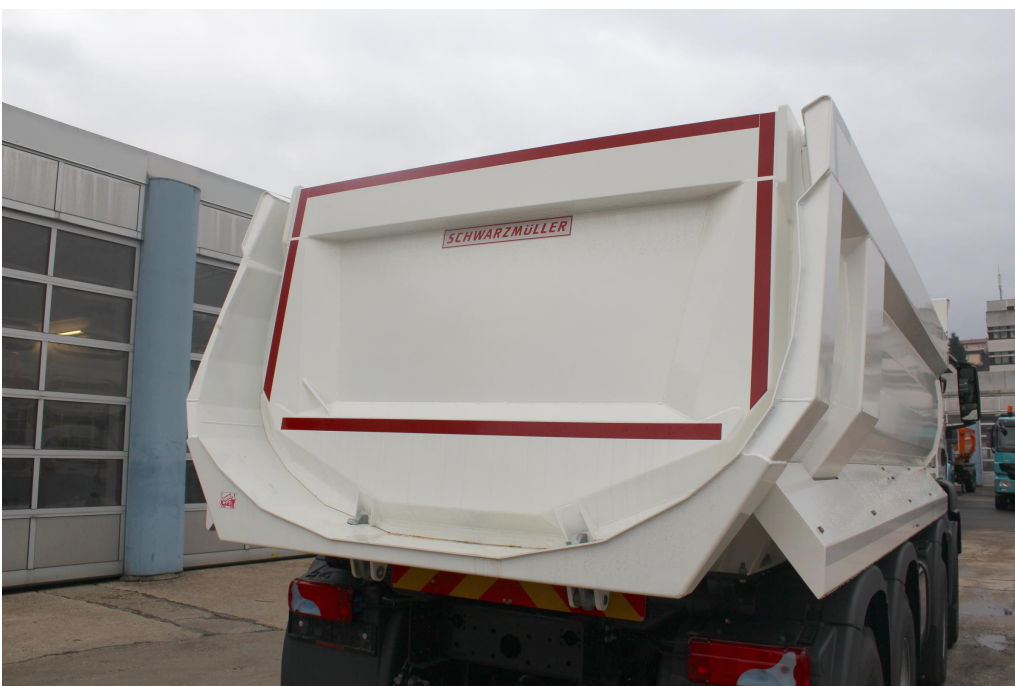
Ściana przednia na górze ze zwiększoną ochroną przed koparką
