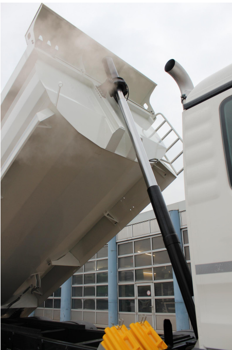
Automatyczna mechaniczna blokada ściany tylnej
