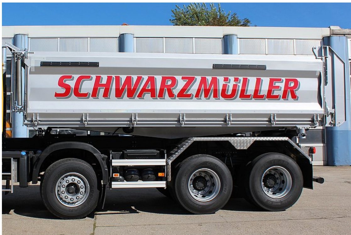
OPCJONALNIE: wzmocnione ściany boczne o konstrukcji membranowej odpornej na działanie materiałów, wykonane z drobnoziarnistej specjalnej blachy stalowej
