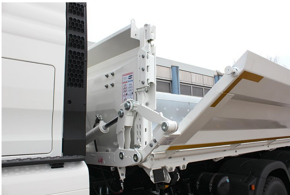
OPCJONALNIE: z lewej strony Bordmatic = hydraulicznie składana burta boczna
