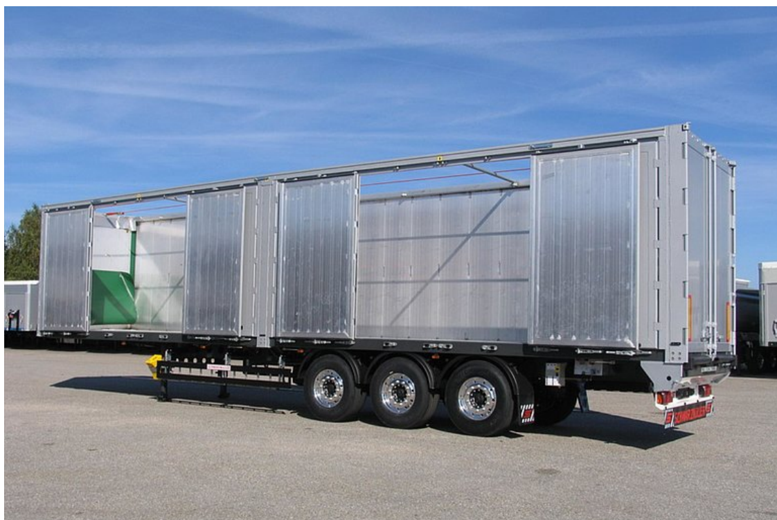
Z lewej strony z 2 szt. drzwi 4-skrzydłowych, do boczego załadunku i rozładunku
