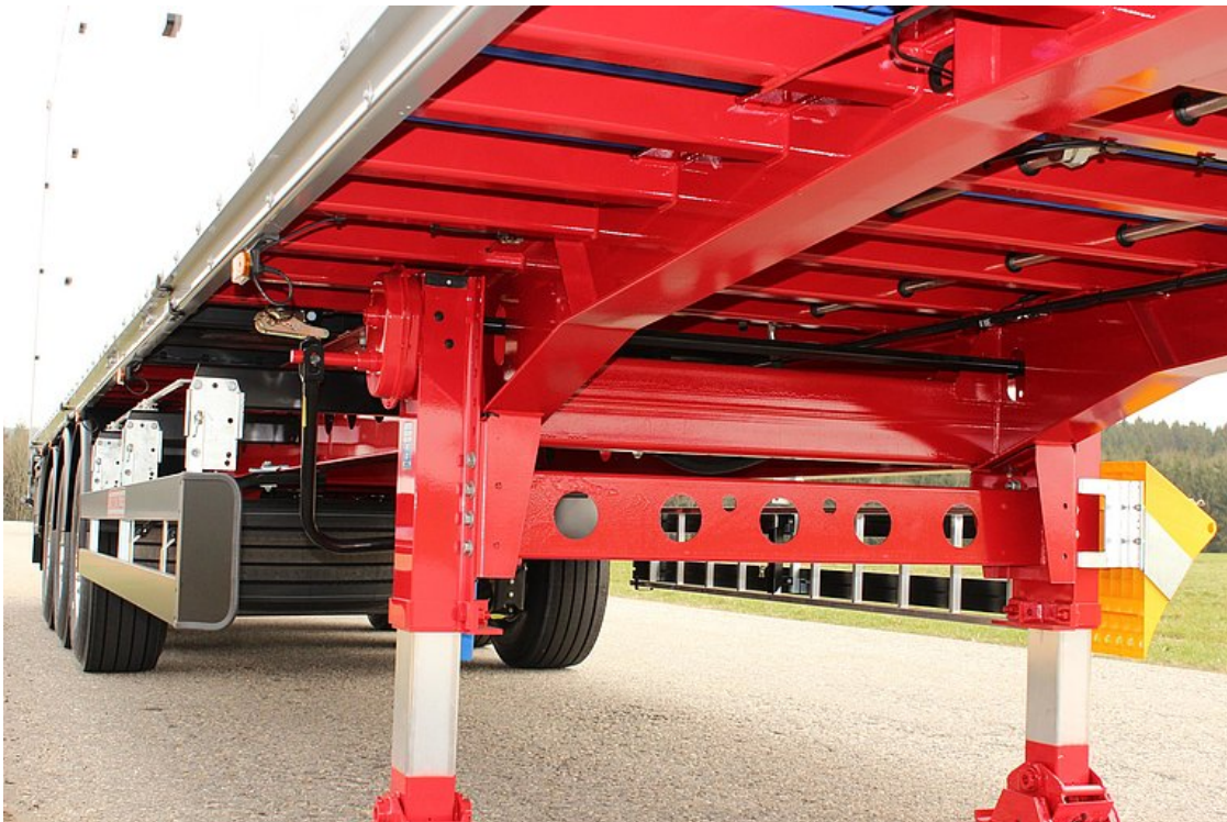
Odporna na skręcanie, ciężka stalowa konstrukcja ramy
