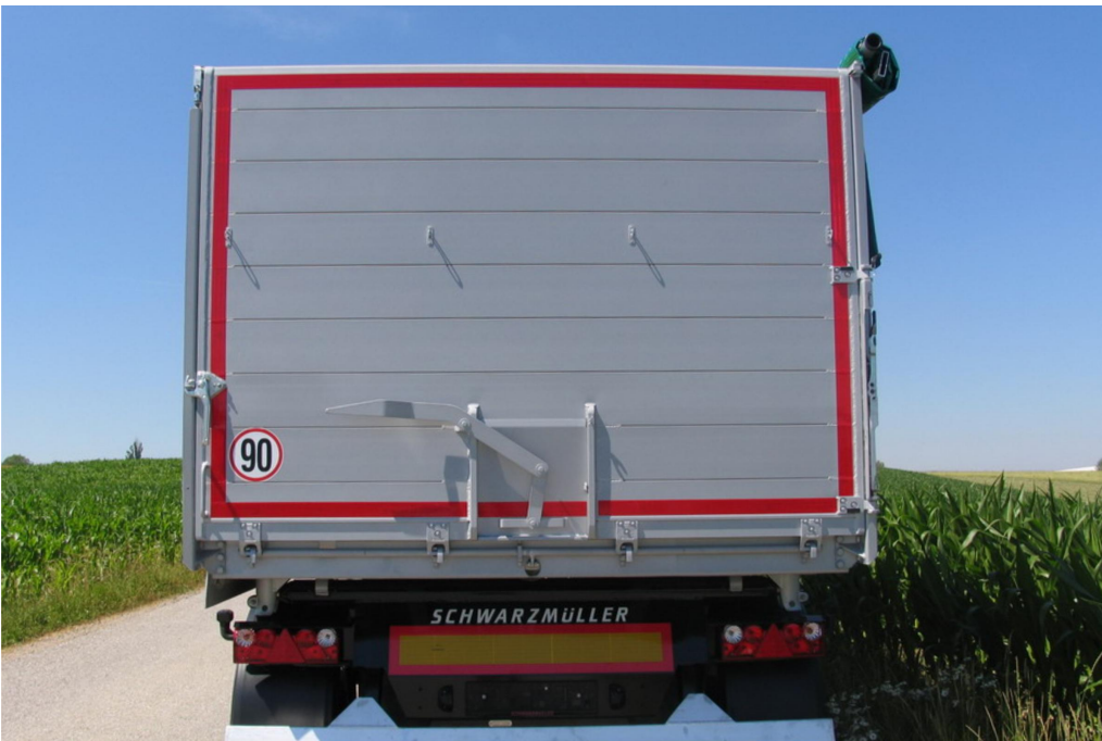
Widok z przodu - stała ściana przednia z blachy stalowej i dyszel z cichym ułożyskowaniem tulejowym
