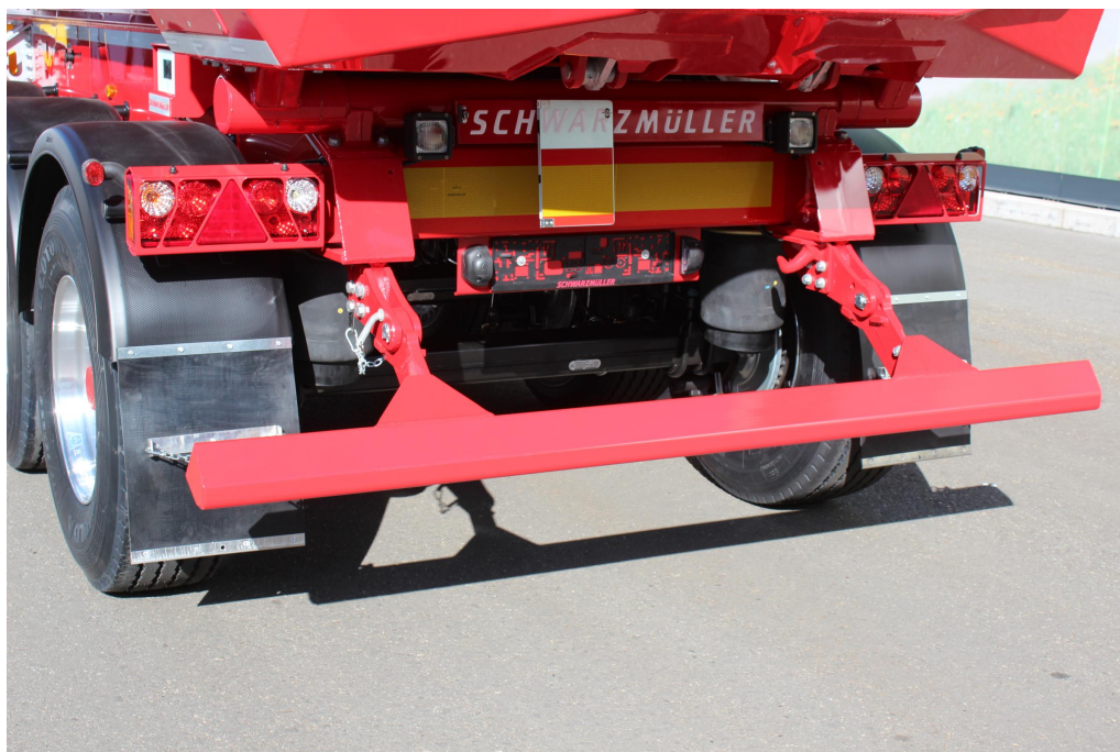
Aluminiowa osłona przeciwnajzdowa, trapezowa, składana, opcjonalnie podnoszona pneumatycznie
