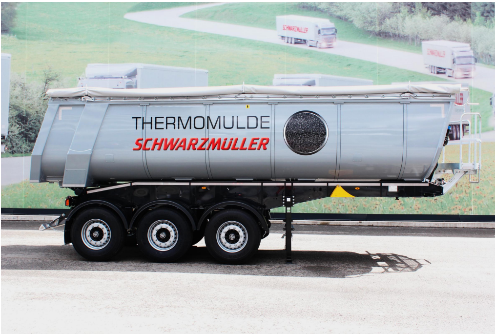
3-osiowa naczepa siodłowa wywrotka aluminiowa ze skrzynią segmentową
