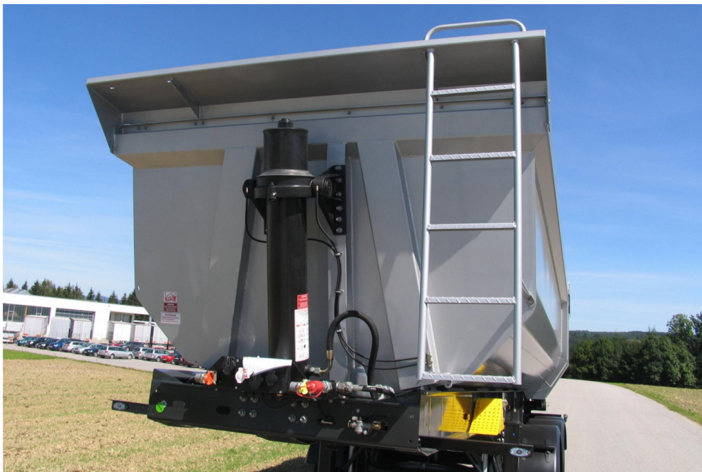
Optymalny rozkład obciążenia dzięki pochyłej ścianie przedniej
