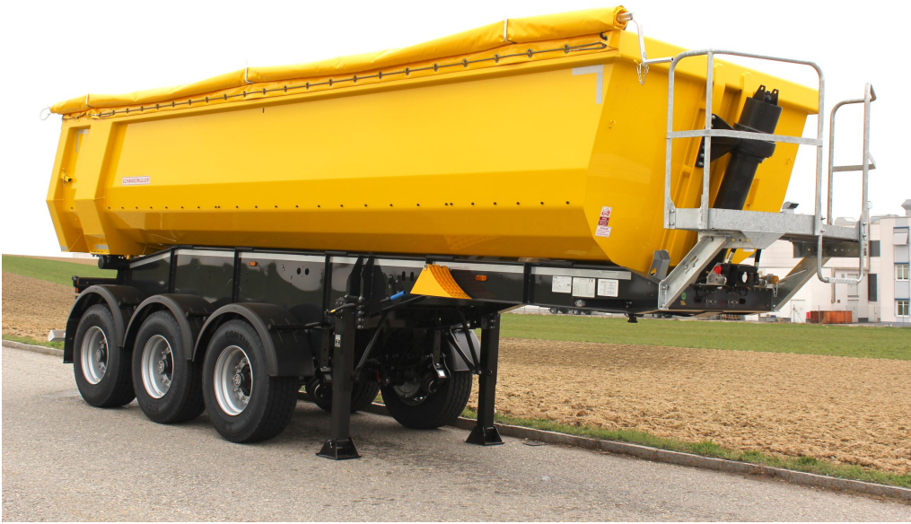
3-osiowa naczepa siodłowa wywrotka aluminiowa ze skrzynią
