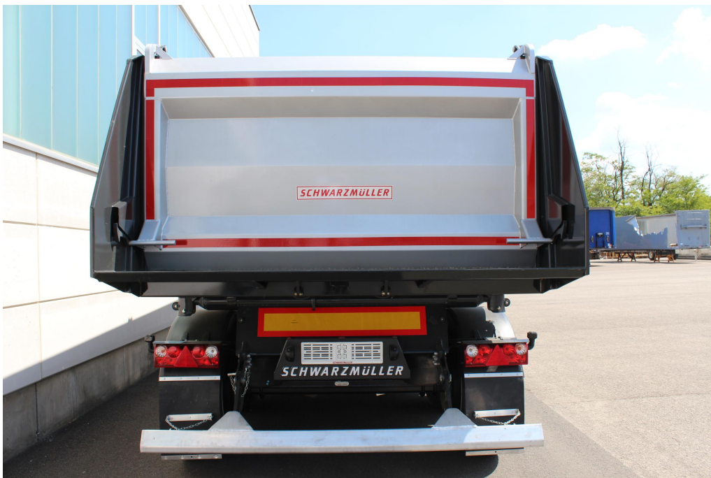
Składana osłona przeciwnajazdowa w przypadku użycia układarki
