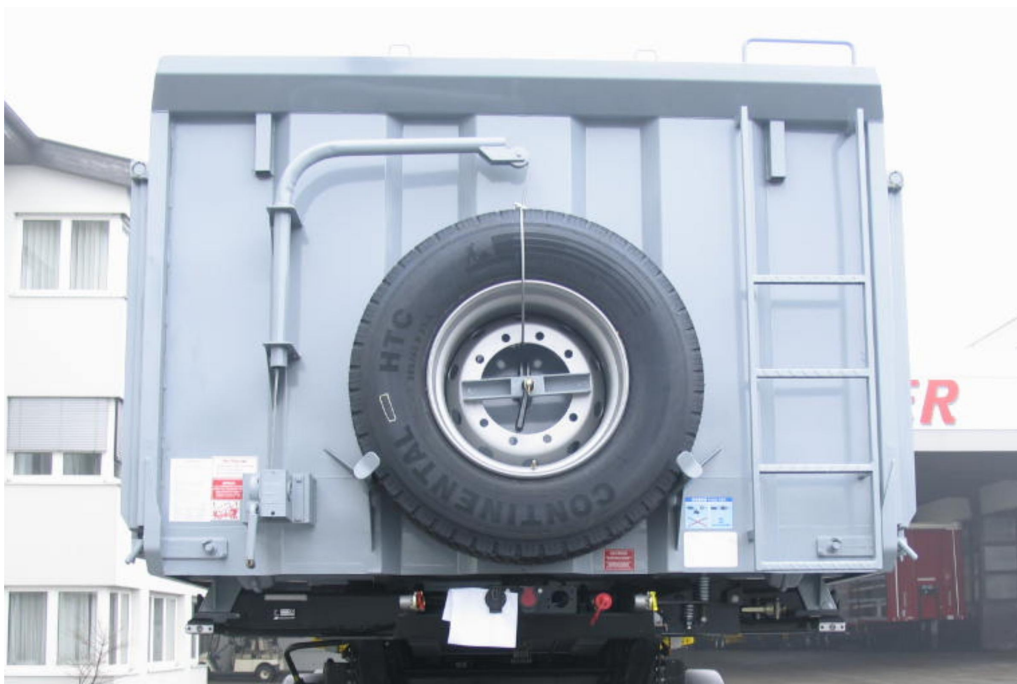
Ręczny zamek centralny do otwierania burt dźwigni i wałkiem zamka centralnego
