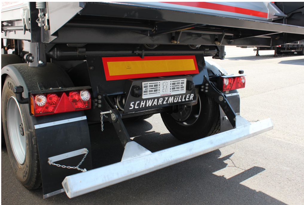
Składana osłona przeciwnajazdowa w przypadku użycia układarki
