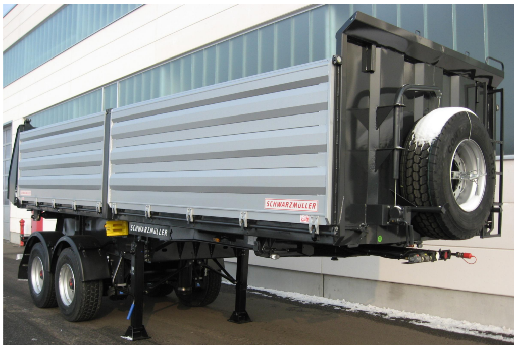
2-osiowa naczepa siodłowa wywrotka trójstronna na budowę
