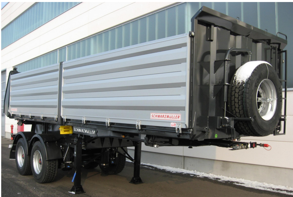
Stała ściana przednia z blachy stalowej z oczkami do mocowania, drabinką i uchwytami pałkowymi
