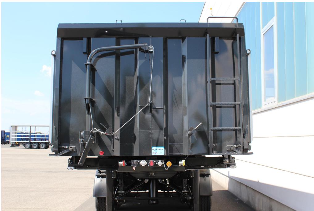
Stała ściana przednia z blachy stalowej z oczkami do mocowania, drabinką i uchwytami pałkowymi
