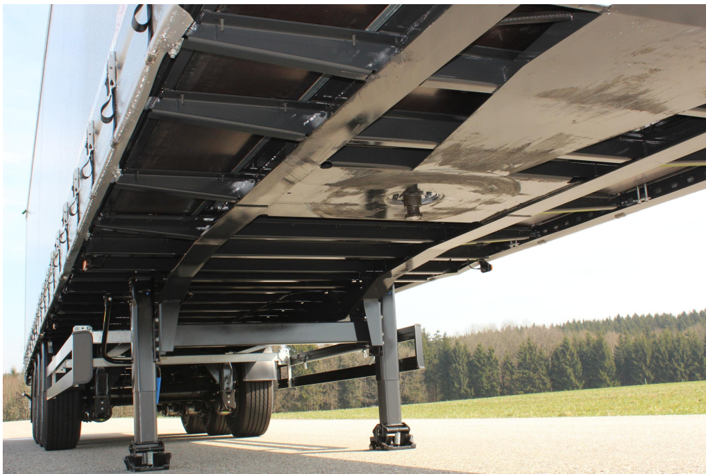
Odporna na skręcanie spawana konstrukcja ramy drabinowej
