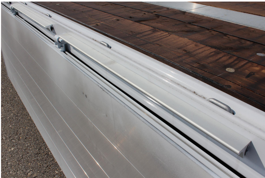
Rama zewnętrzna z 15 parami wpuszczonych uchwytów mocujących do zabezpieczenia ładunku
