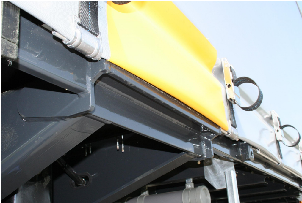
Konstrukcja ramy wzmocniona 4 krawędziami chwytającymi do załadunku suwnicą na wagony kolejowe
