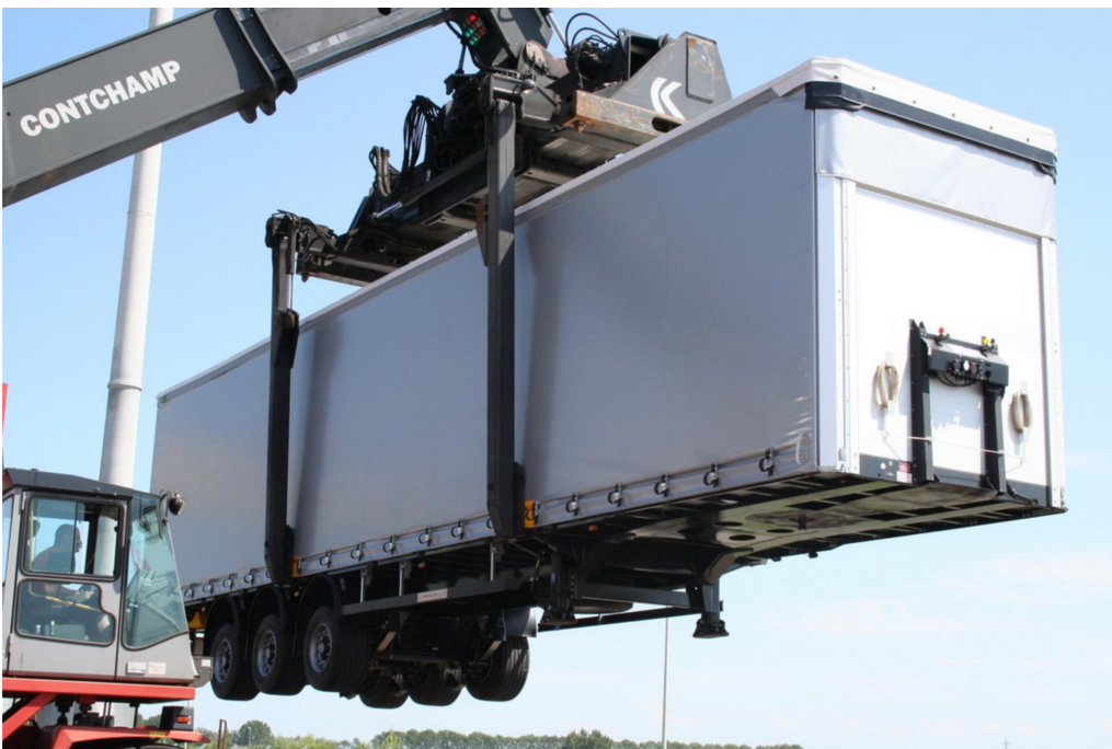
Konstrukcja ramy wzmocniona 4 krawędziami chwytającymi do załadunku suwnicą na wagony kolejowe
