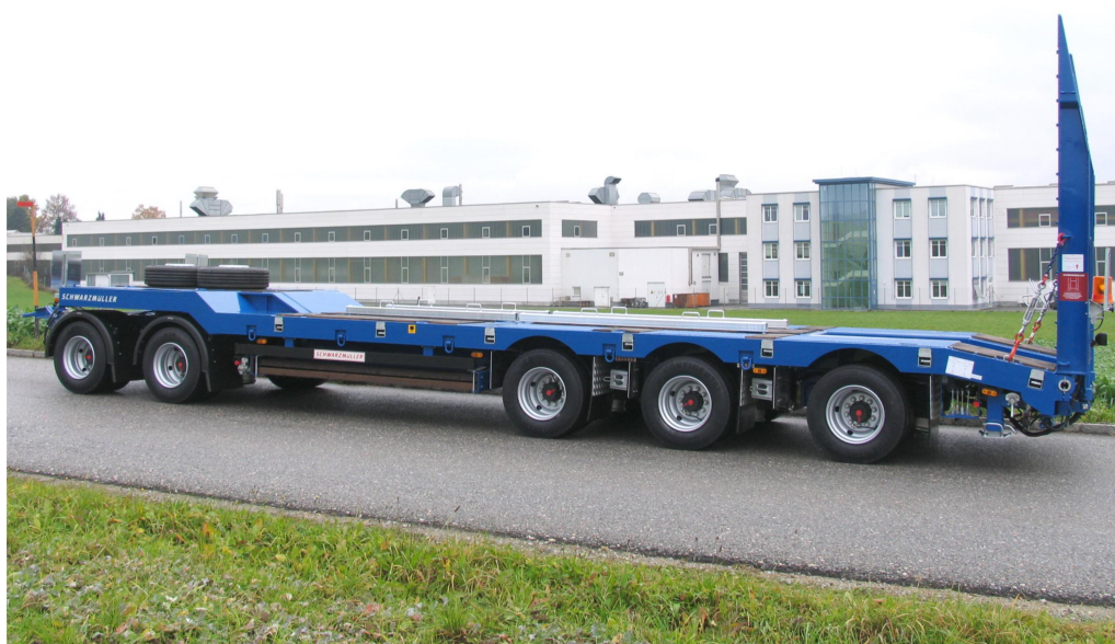
5-osiowa przyczepa niskopodwoziowa z platformą załamaną
