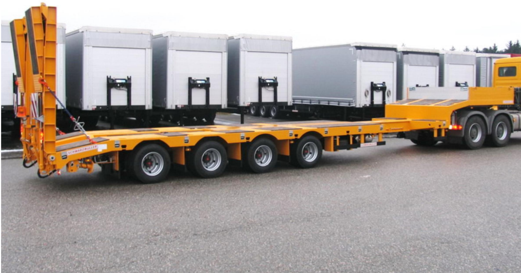
4-osiowa naczepa siodłowa niskopodwoziowa, wersja wzmocniona, rozciągana
