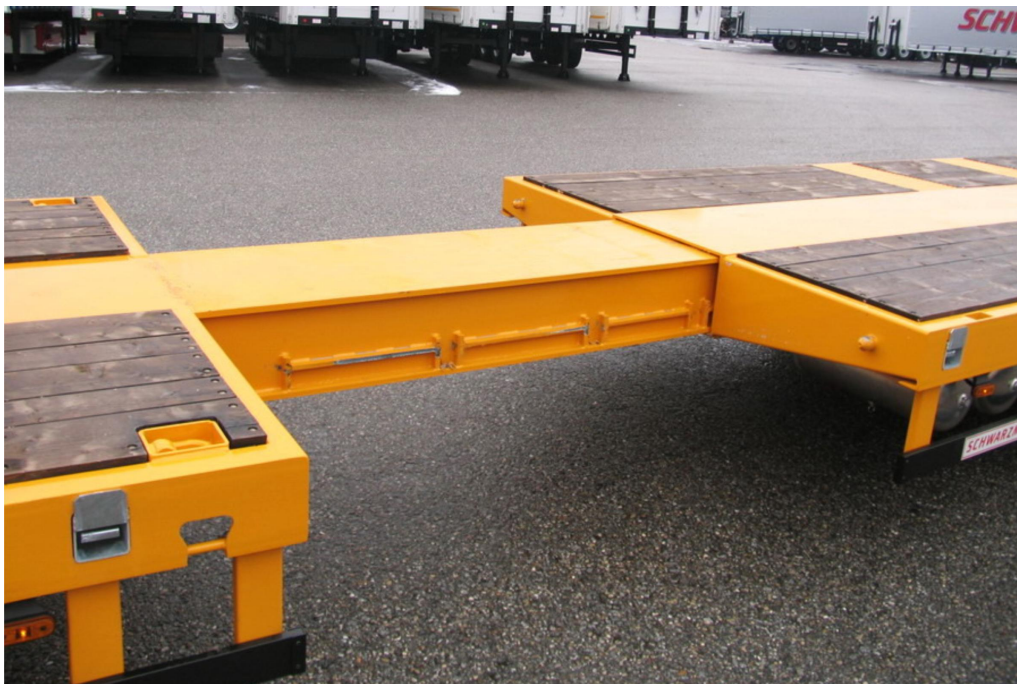
Rozciągana rama centralna, regulowana stopniowo z blokadą pneumatyczną
