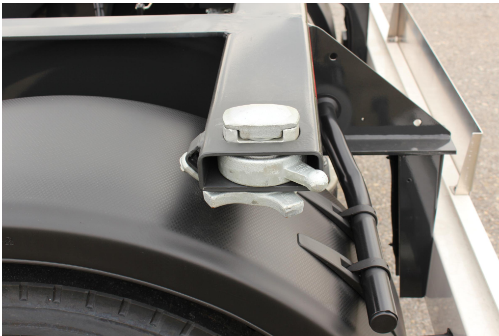
Belka poprzeczna podpierająca z zamkami do kontenerów zgodnie z normą EN 284
