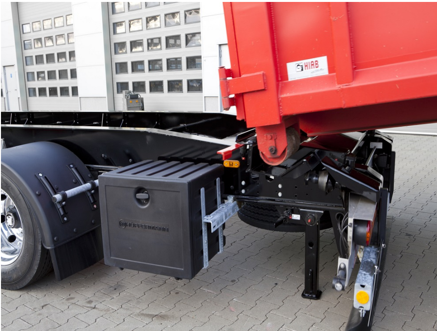
Tylne podparcie umożliwiające bezpieczne przekładanie
