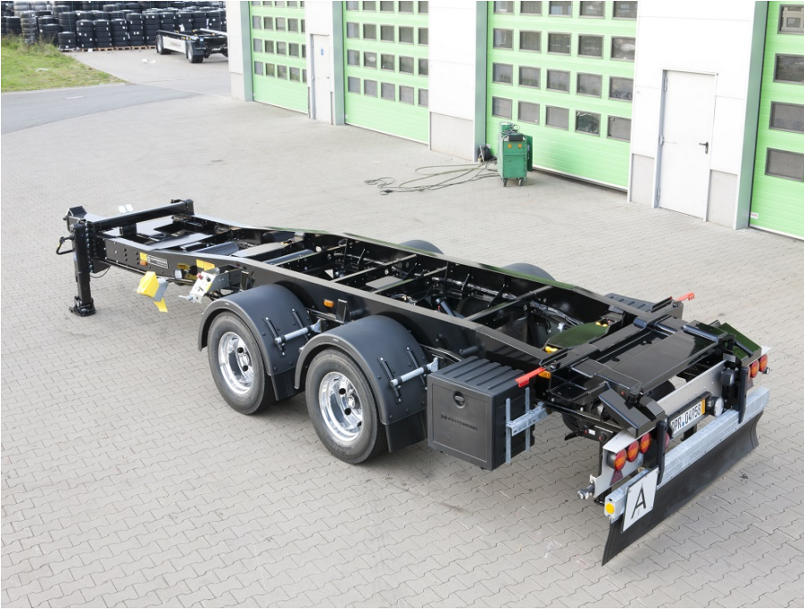
Wyposażenie specjalne z 3 okrągłymi lampami LED i lakierowanymi saniami
