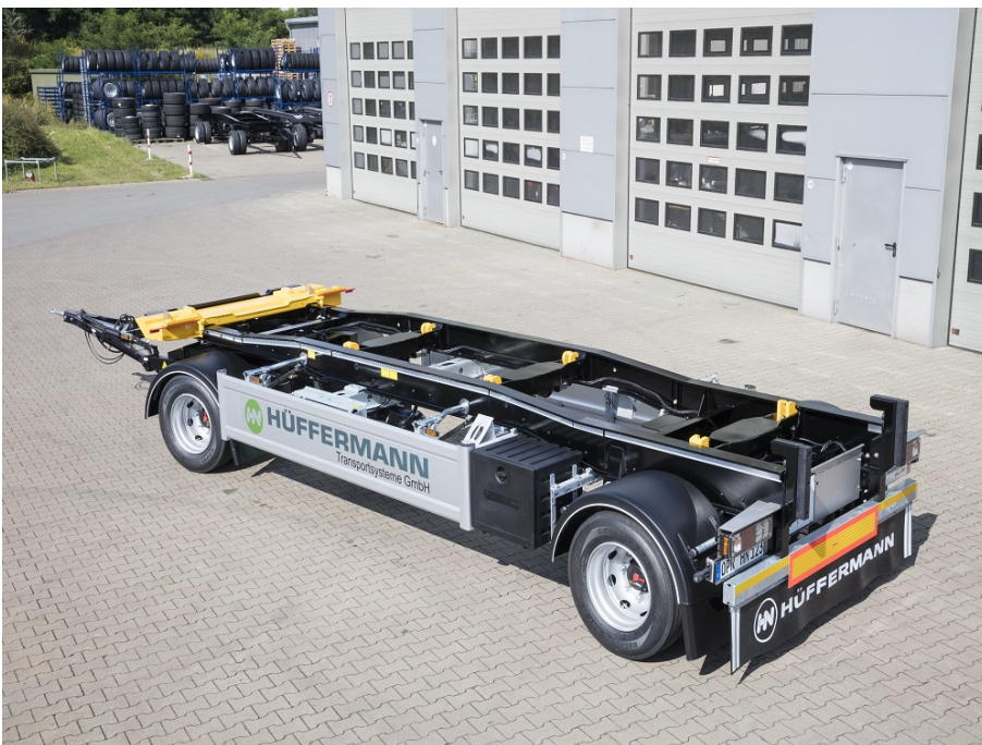
Opuszczony dyszel widłowy w przypadku załadunku przodem
