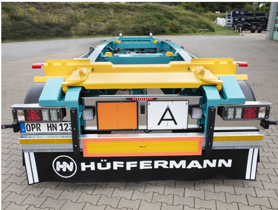
Widok od tyłu z tablicą ECE, tablicą ostrzegającą o przewozie odpadów i tablicą ADR
