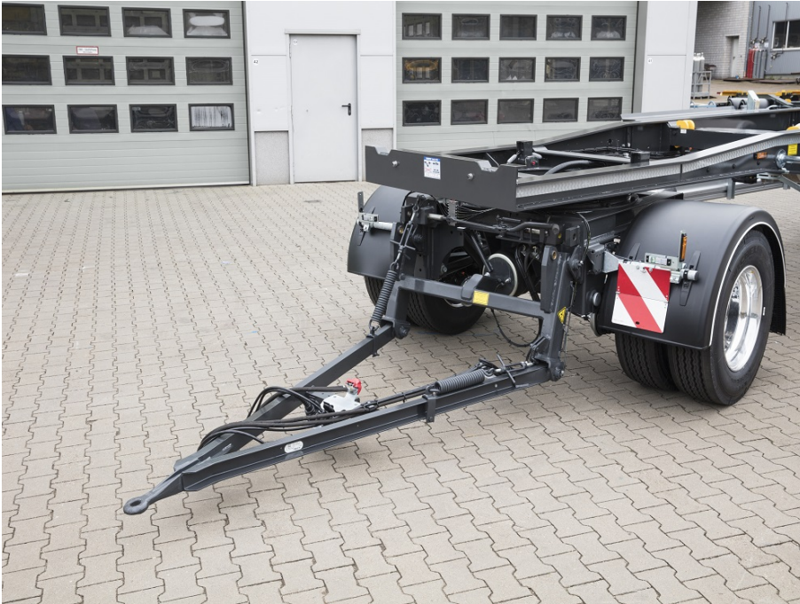
Opuszczony dyszel widłowy w przypadku załadunku przodem
