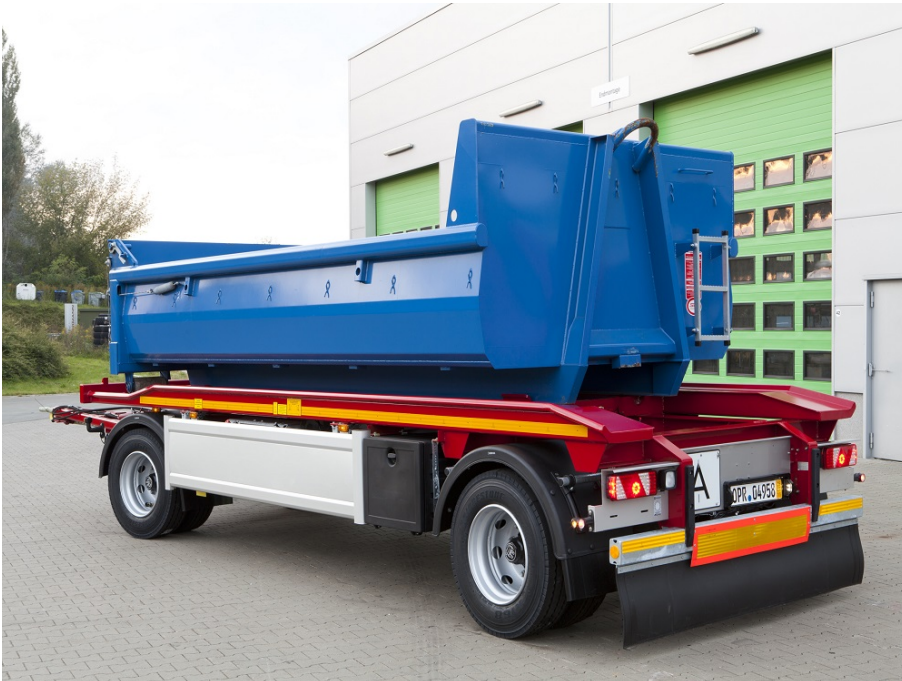
Wszechstronna naczepa do przewozu krótkich kontenerów rolkowych
