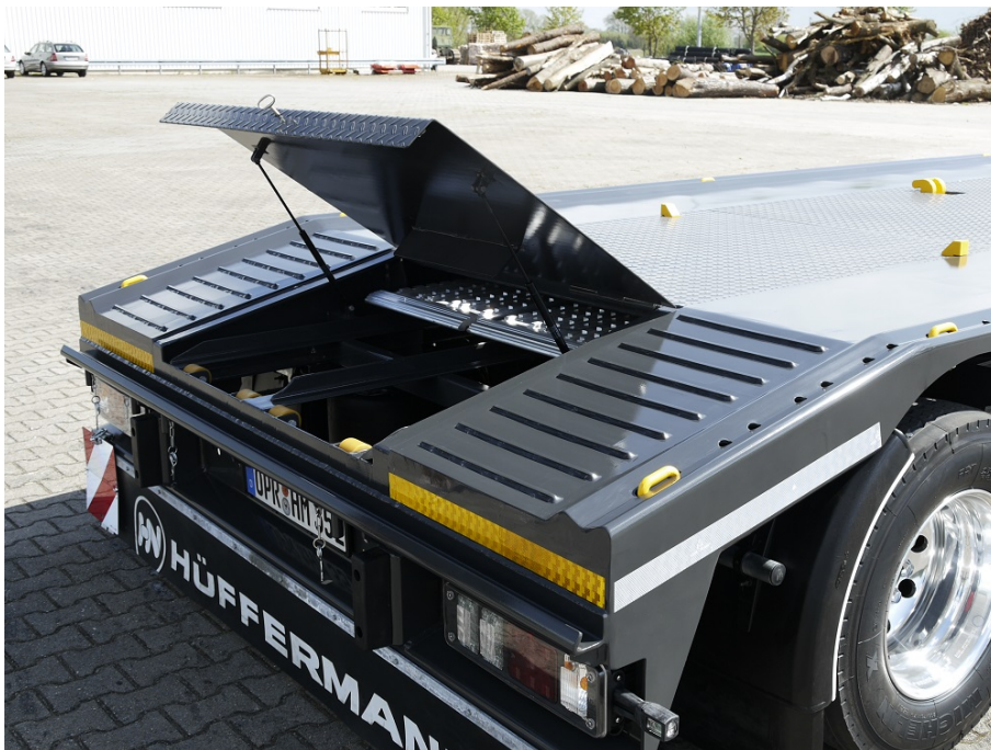
Schówek na rampy najazdowe w wyposażeniu standardowym
