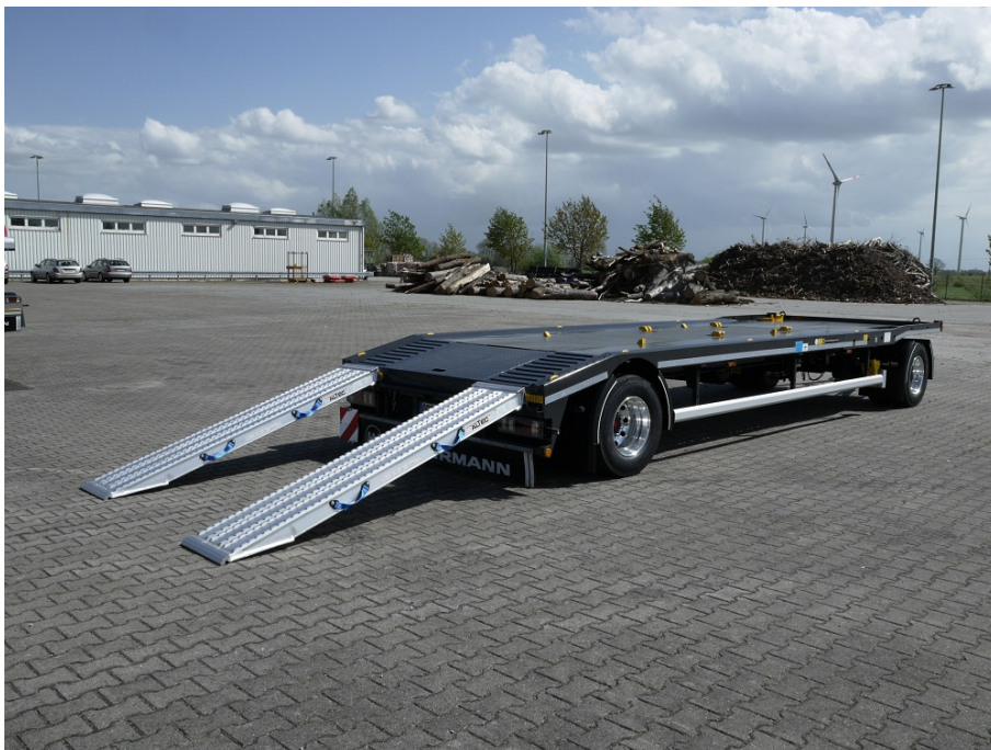
Naczepa 2-osiowa Multi-Carrier z rampami najazdowymi
