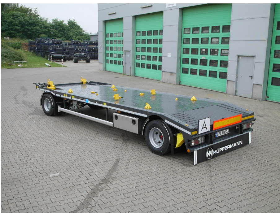
Naczepa 2-osiowa Multi-Carrier z rampami najazdowymi
