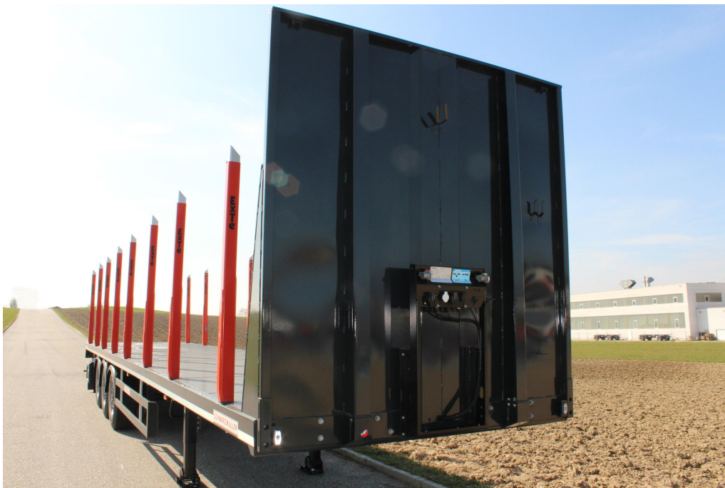
Ściana przednia z bardzo mocnych profili stalowych z podporami środkowymi
