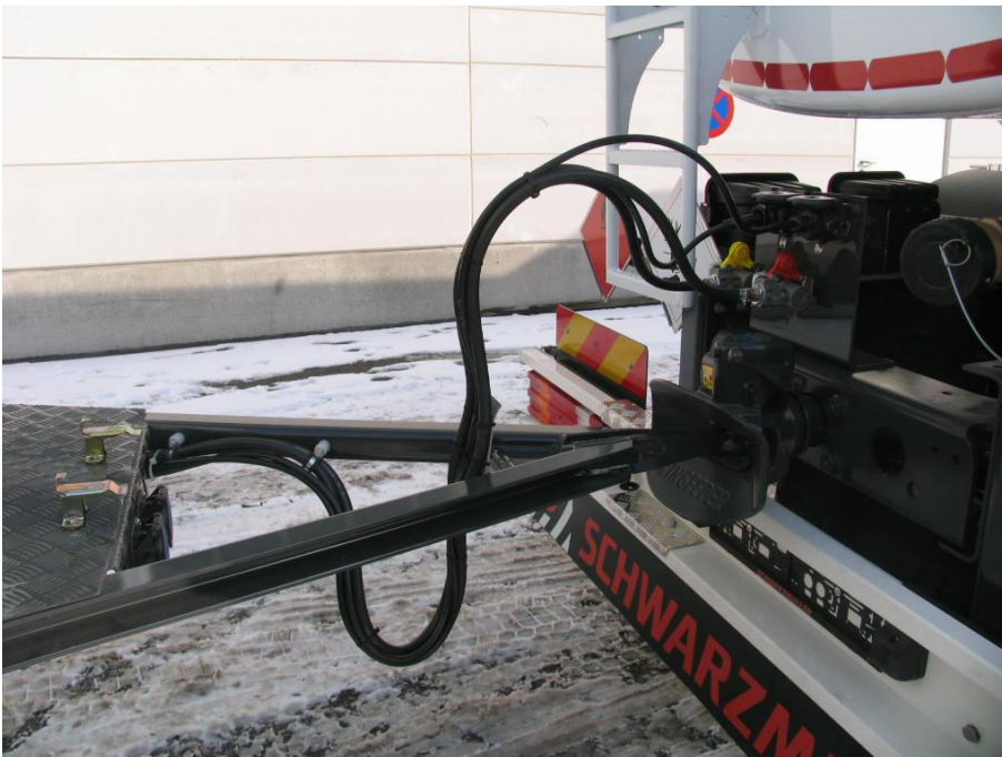
Przyjazne dla użytkownika rozmieszczenie armatury na wlocie
