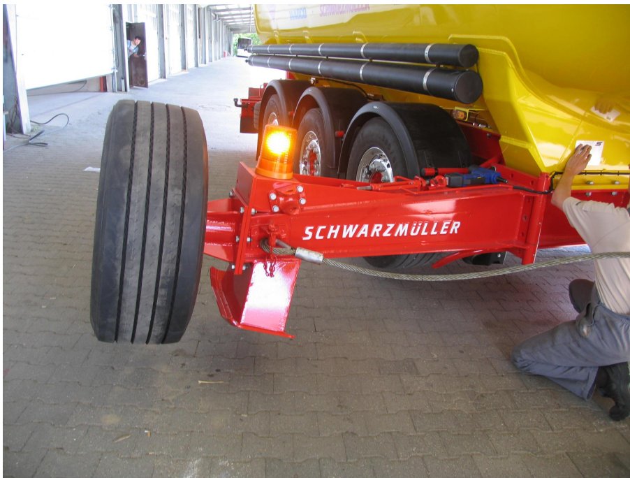
Wysięgnik z urządzeniem przeciwwzgięciowym wraz z liną przeciwwzgięciową i światłem obrotowym na ramie podwozia z prawej strony
