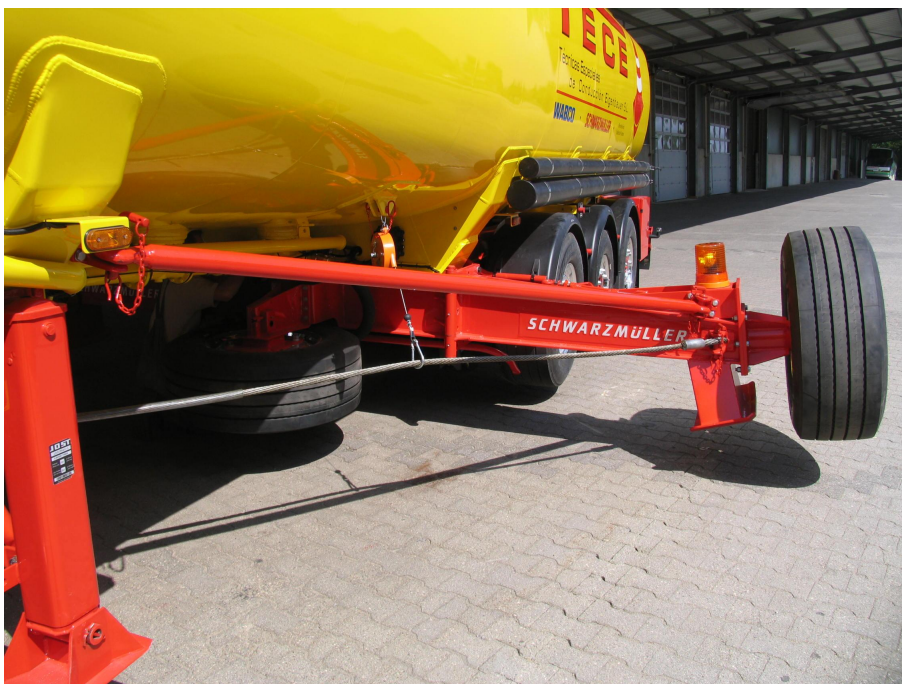
Wysięgnik z urządzeniem przeciwwzgięciowym wraz z liną przeciwwzgięciową i światłem obrotowym na ramie podwozia z prawej strony
