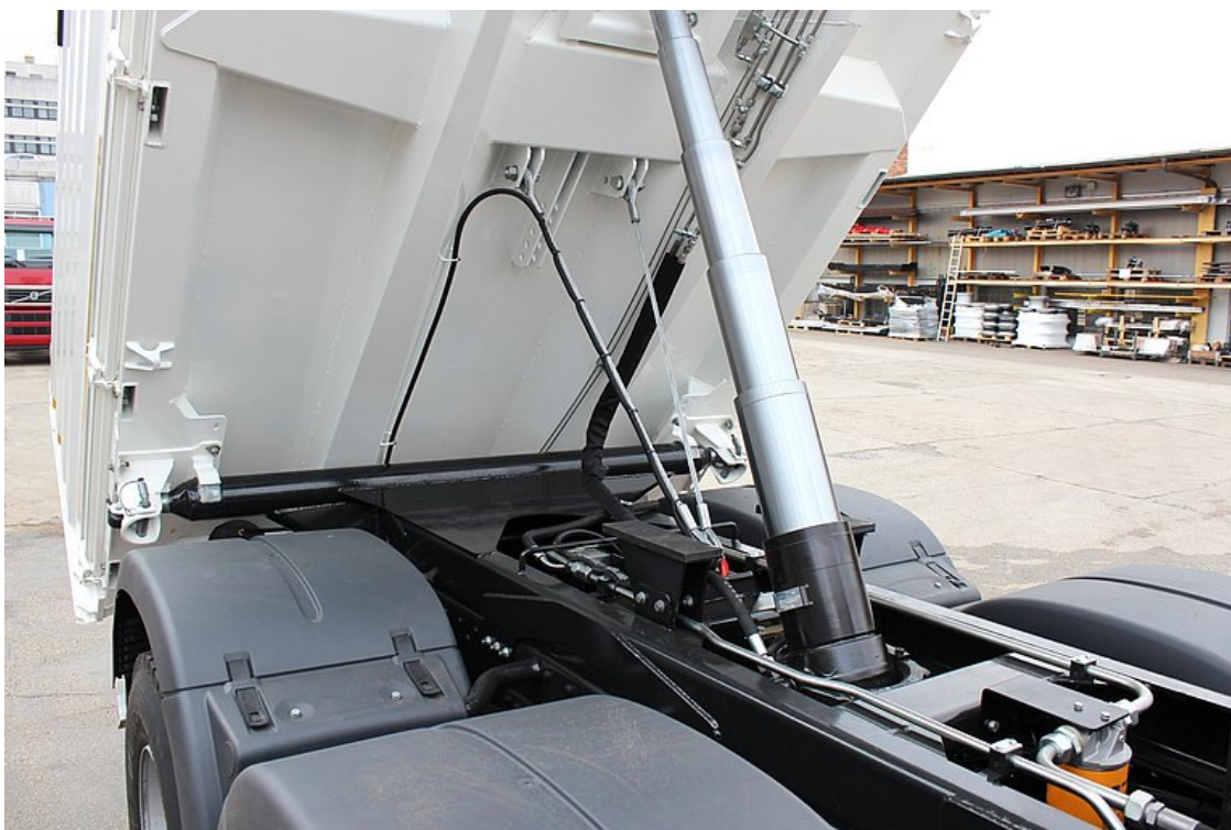
Chromowany na twardo, wysokiej jakości siłownik wywrotu
