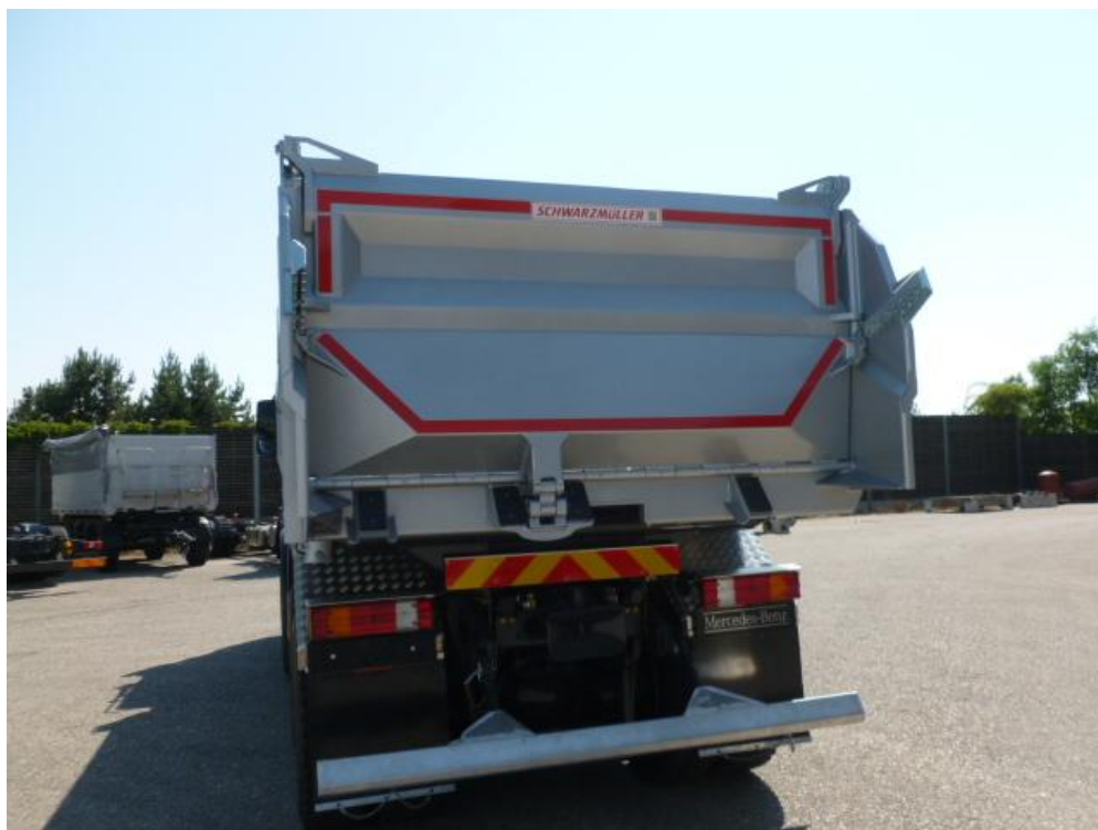
Ściana tylna z blachy stalowej 4 mm, wysokość ok. 980 mm, wahadłowa ze zwiększonym ułożyskowaniem i blokadą pneumatyczną, otwierana z kabiny kierowcy oraz dodatkowo składana do pewnego stopnia
