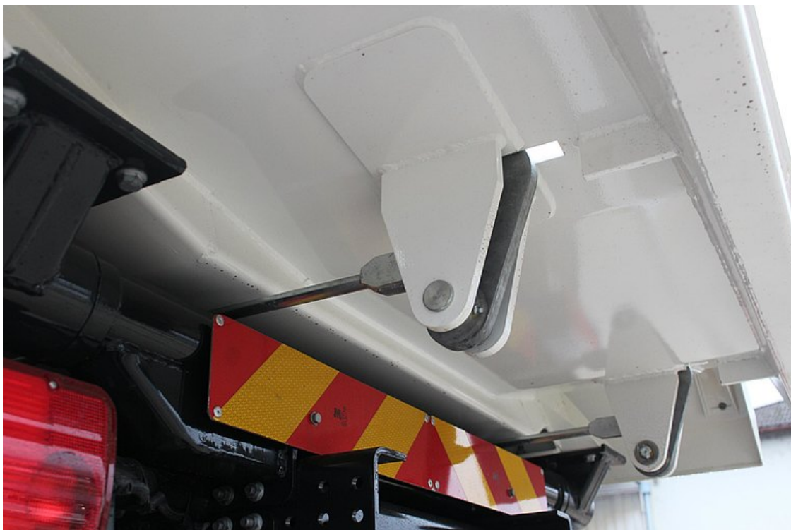
Automatyczna mechaniczna blokada ściany tylnej
