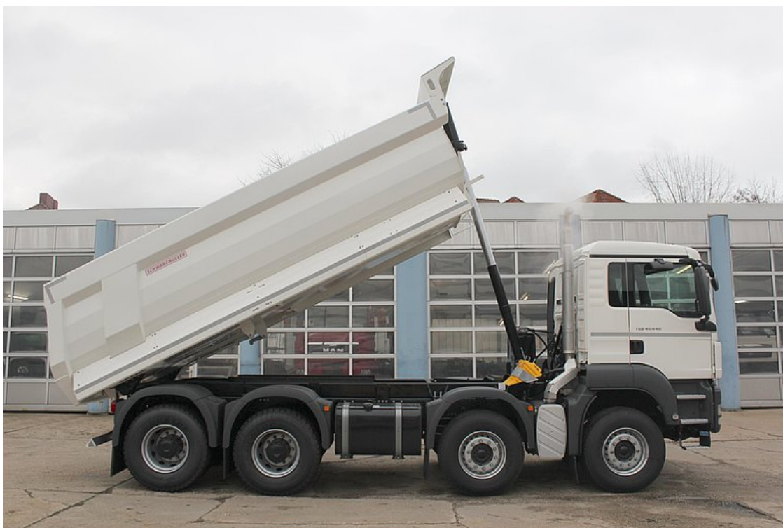
Nadwozie stalowe wywrotki ze skrzynią segmentową do 4-osiowego samochodu ciężarowego
