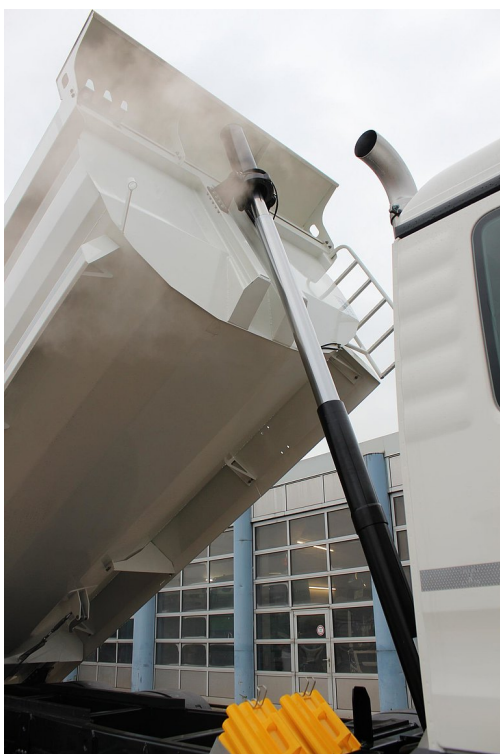
Chromowany na twardo, wysokiej jakości przedni siłownik przechyłu
