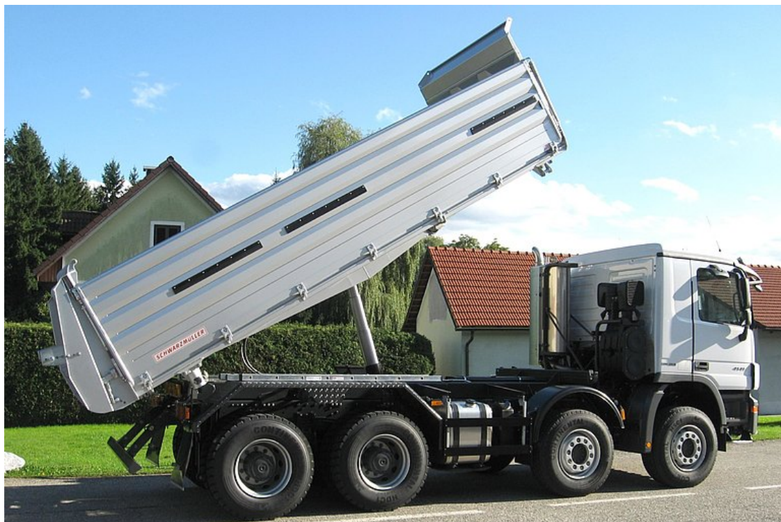
Nadwozie wywrotki trójkątnej do 4-osiowego samochodu ciężarowego na budowę
