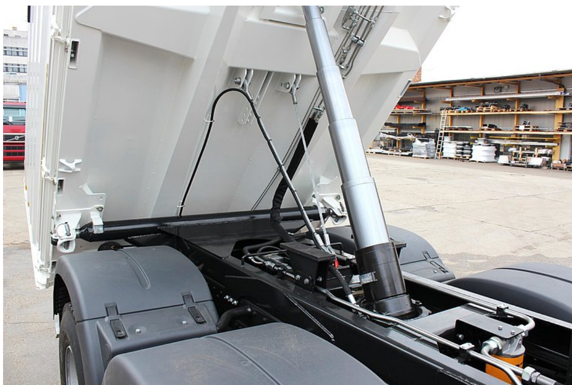
Chromowany na twardo, wysokiej jakości siłownik wywrotu
