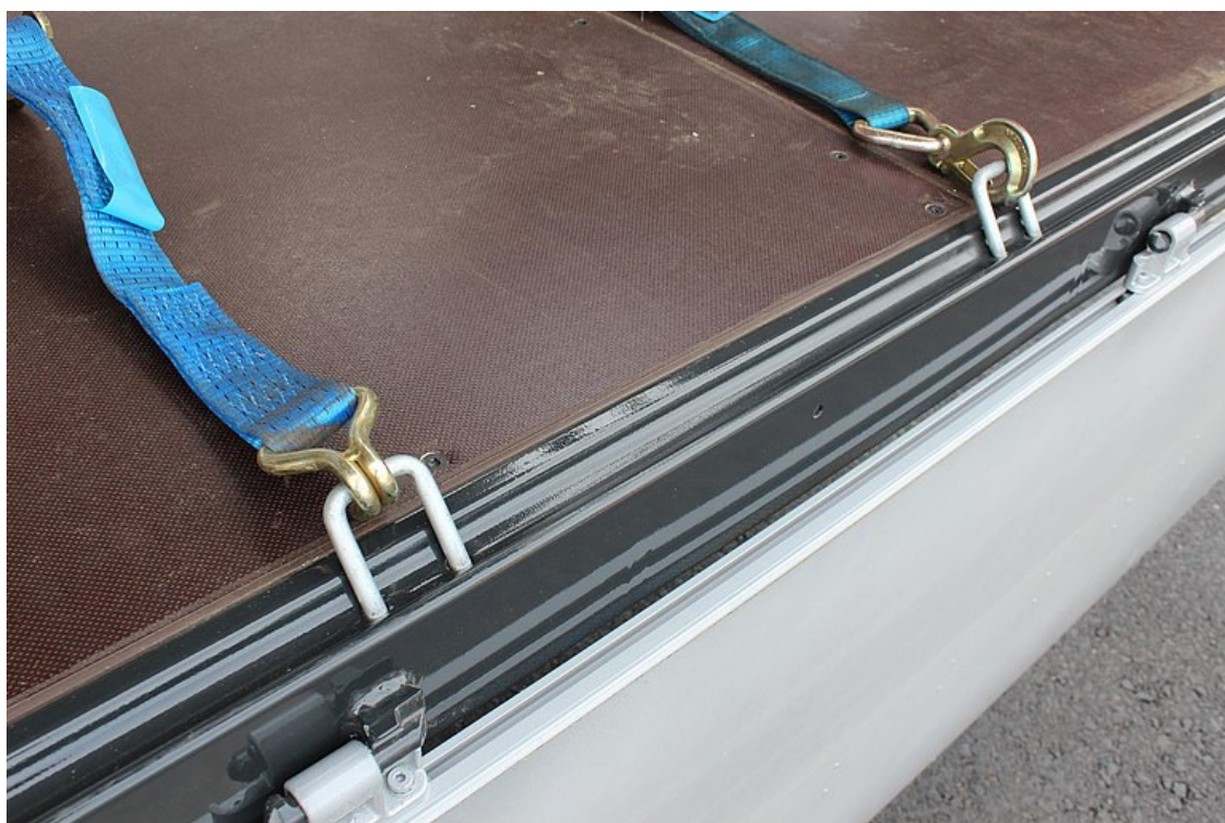
Rama zewnętrzna z wpuszczonymi uchwytami mocującymi 2,5 t
