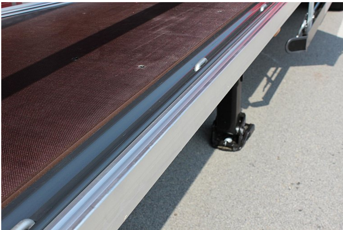
Przykręcona po obu stronach aluminiowa listwa przeciwuderzeniowa kombinowana, jako dodatkowa osłona przeciwnajazdowa, ze zintegrowanym zawieszeniem plandeki i zamocowaniem łąt
