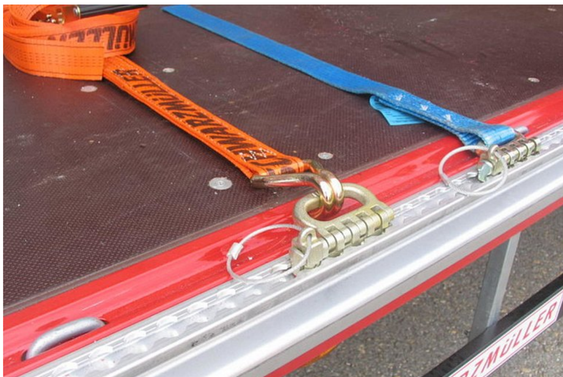
OPCJONALNIE: zmienne zabezpieczenie ładunku za pomocą przykręcanych systemów mocujących - np. szyny mocującej Airline
