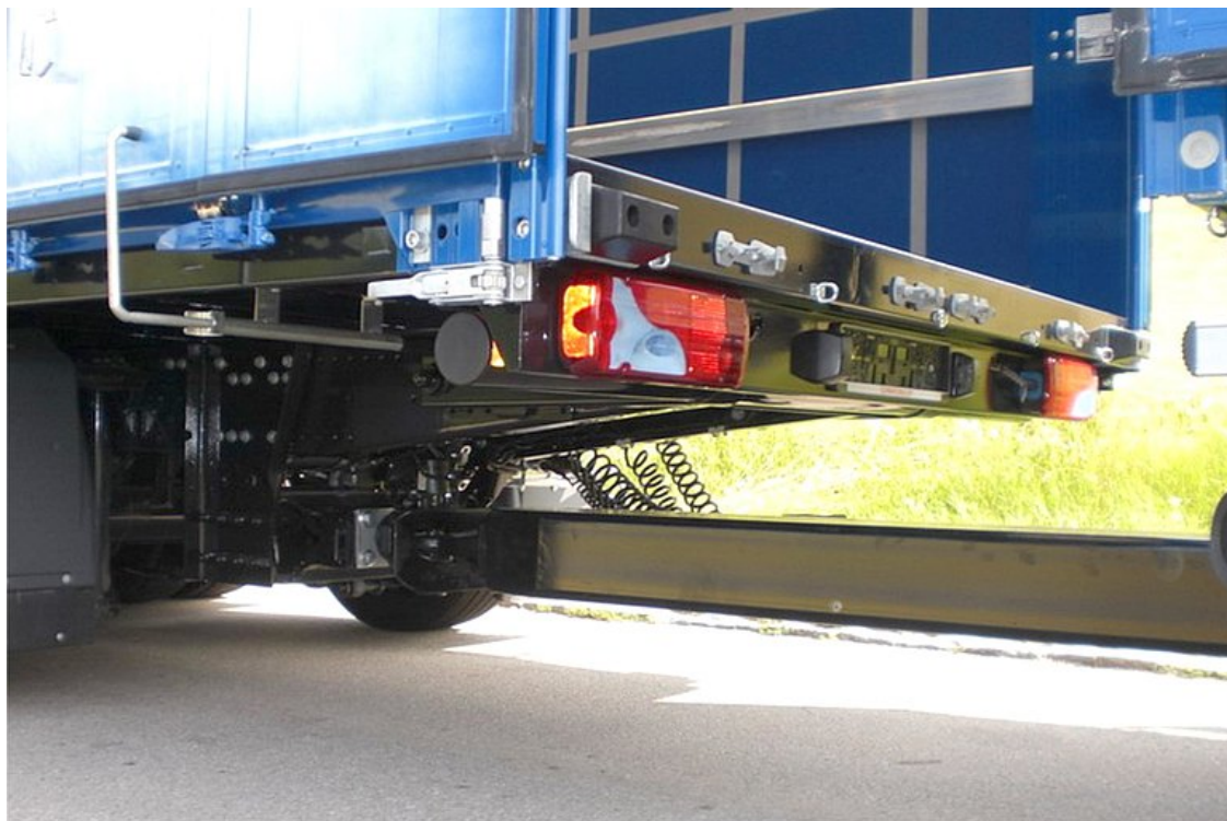
Specjalny zaczep holowniczy do przyczep z osią centralną na krótkie odległości
