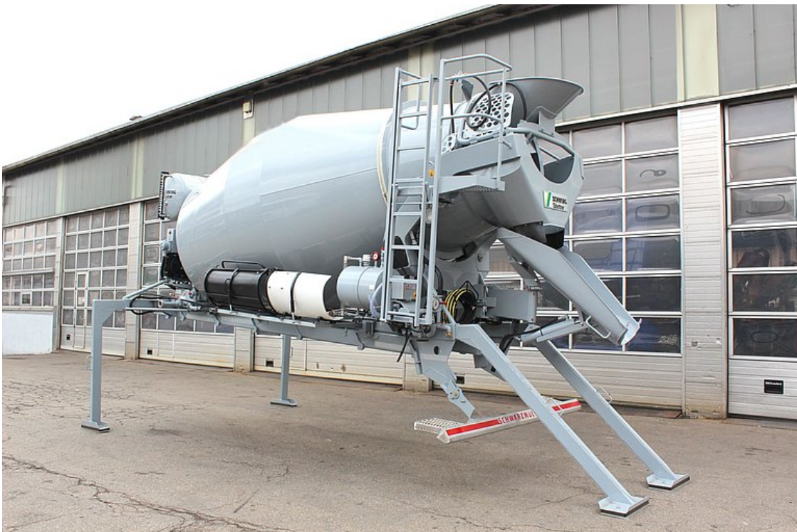
Nadwozie betoniarki po odstawieniu
