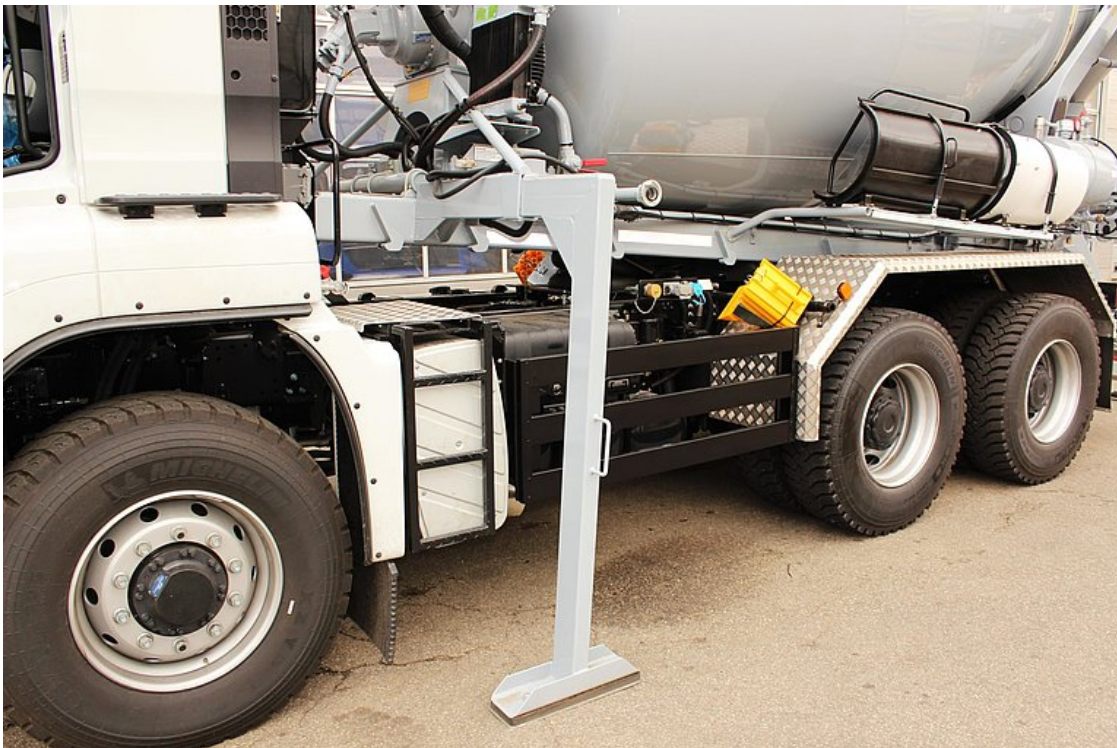
Przednie podpory do szybkiej i łatwej wymiany nadwozia
