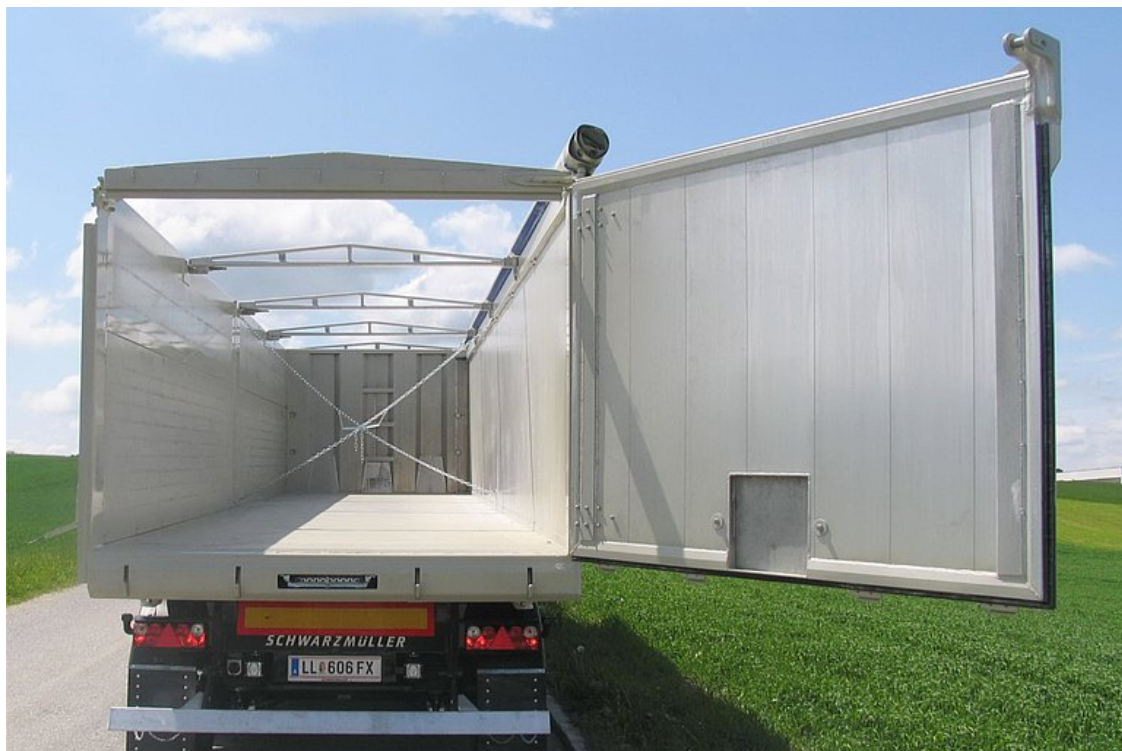
Łączona ściana tylna - 1-skrzydłowe drzwi w pełni otwierane i dodatkowo wahadłowe z automatycznym zamkiem pneumatycznym
