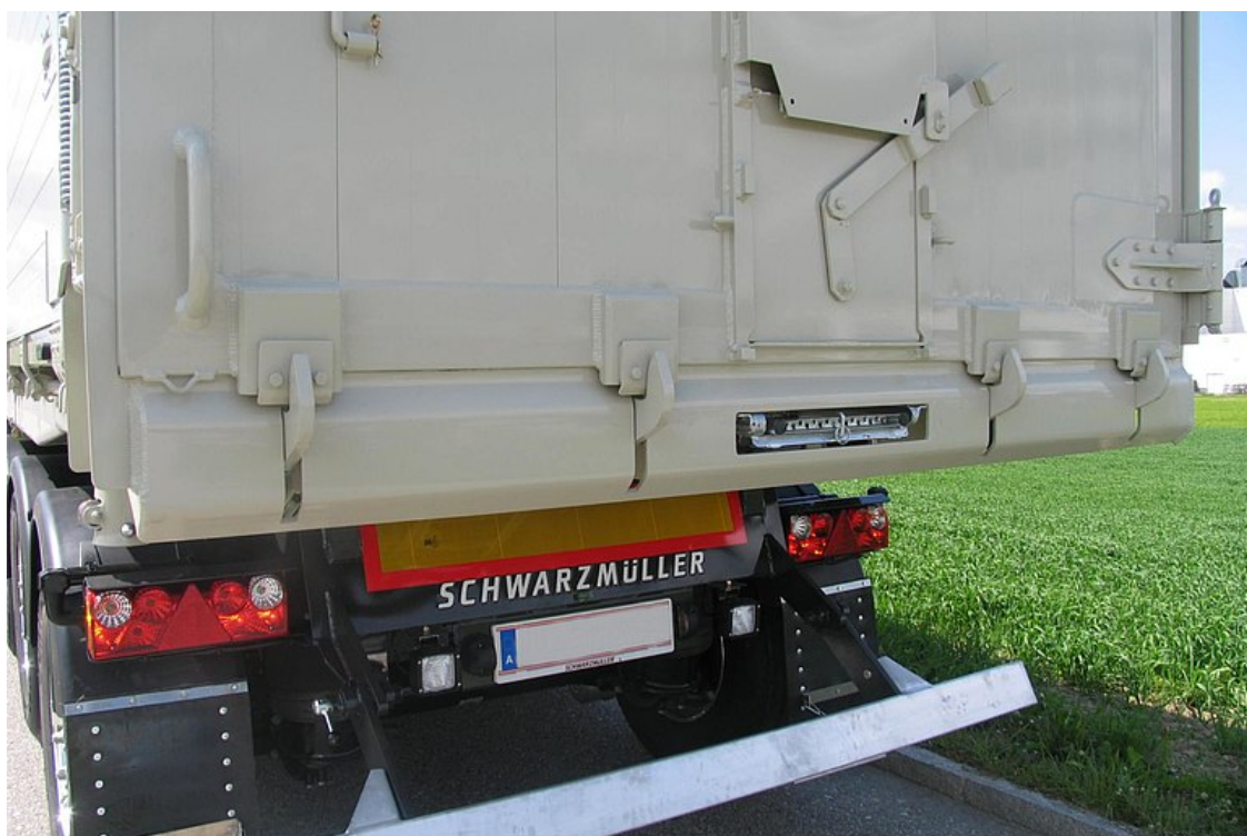
Kombinowana tylna ściana wraz z szufladą na zboże i wsuwaną drabinką
