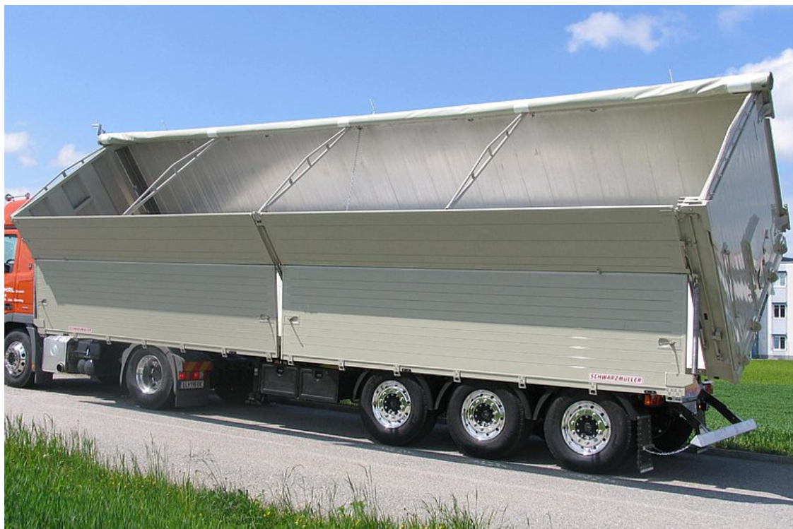
2-częściowe ściany boczne wraz ze zdejmowanym słupkiem środkowym, aby mieć maksymalną szerokość załadunku
