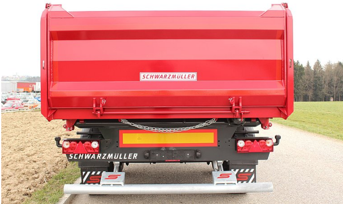
Tylna ściana z blachy stalowej, wahadłowa, ze zwiększonym ułożyskowaniem i automatycznym zamknięciem pneumatycznym
