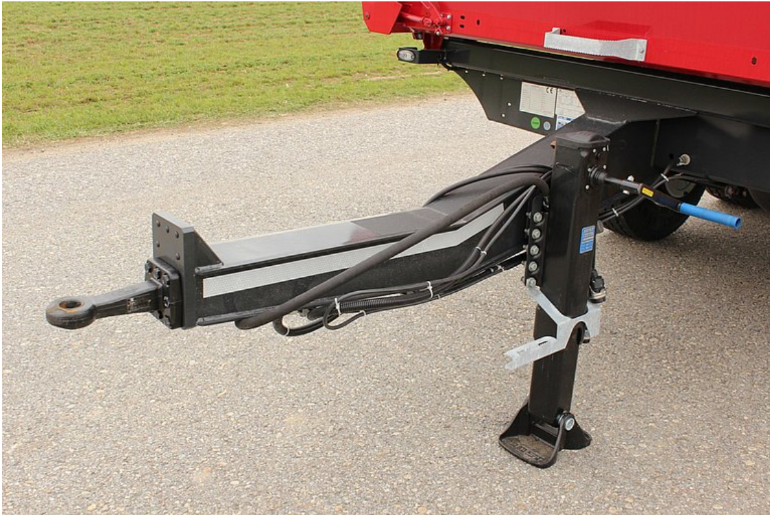
Dyszel wygięty z uchem dyszla o regulowanej wysokości wraz z 1 stopniem wejściowym w kierunku jazdy z lewej strony
