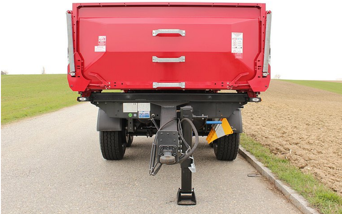
Ściana przednia z blachy stalowej ze stopniami wejściowymi wewnątrz i na zewnątrz
