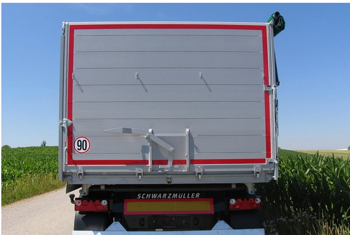
Ściana tylna z aluminiowych profili zamkniętych, składana i dodatkowo wahadłowa z ręcznym zamkiem centralnym
