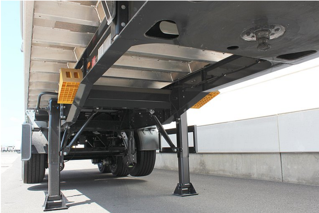
Stabilna i odporna na skręcanie konstrukcja podwozia z dodatkowymi rurami odpornymi na skręcanie
