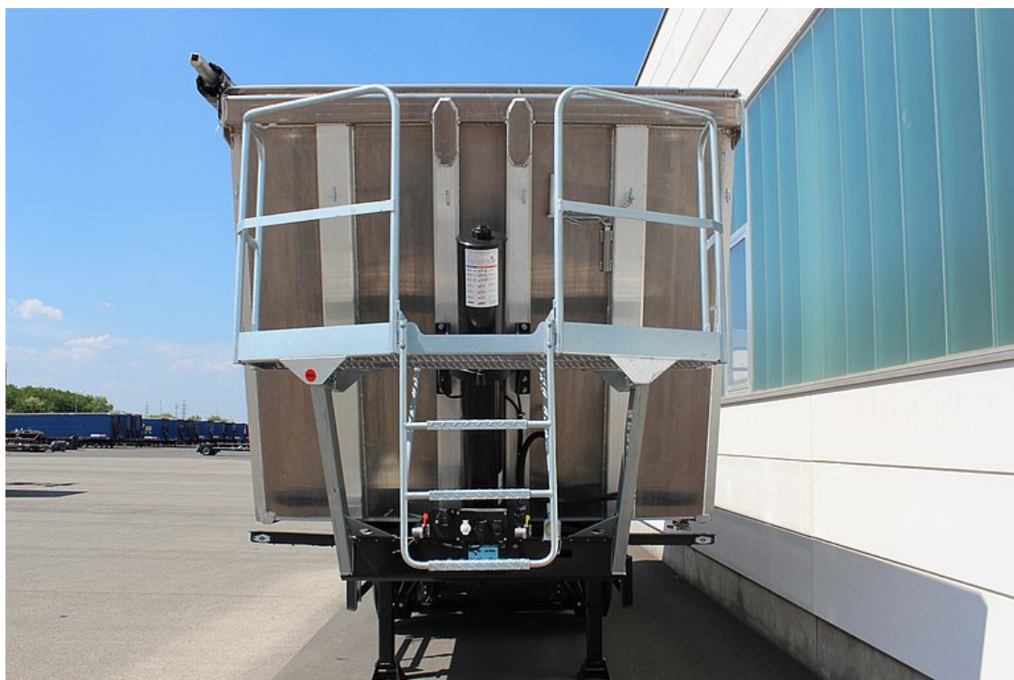
Podest stojący na ścianie przedniej do obsługi plandeki rolkowej
