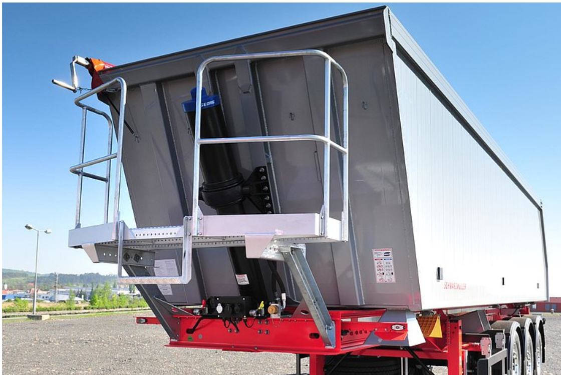
Optymalny rozkład obciążenia dzięki pochyłej ścianie przedniej
