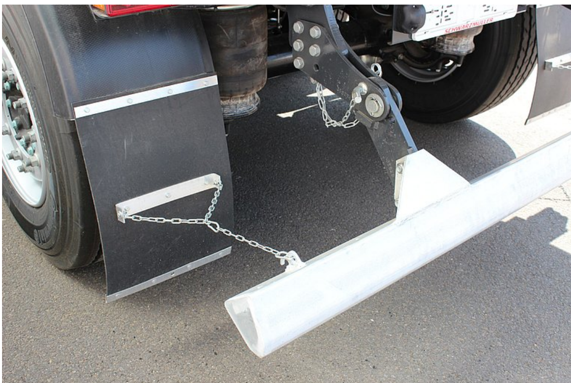
Aluminiowa osłona przeciwnajazdowa, trapezowa, składana
