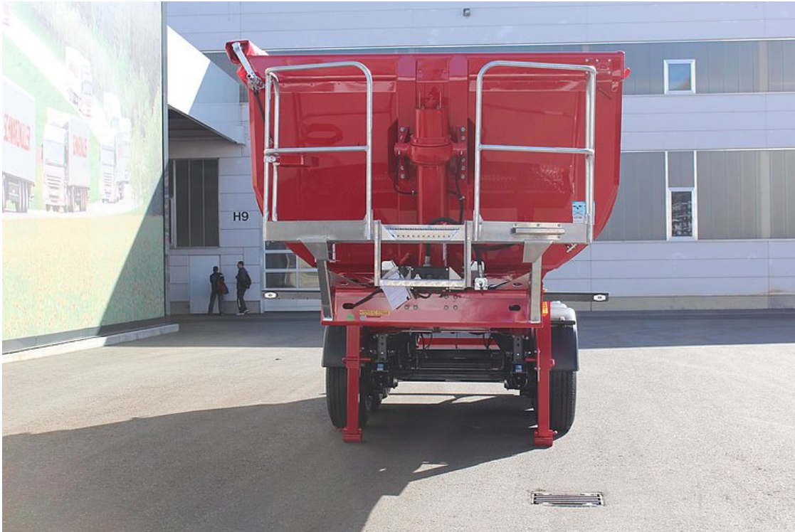
Izolowana ściana przednia z chromowanym na twardo, wysokiej jakości przednim siłownikiem przechyłu
