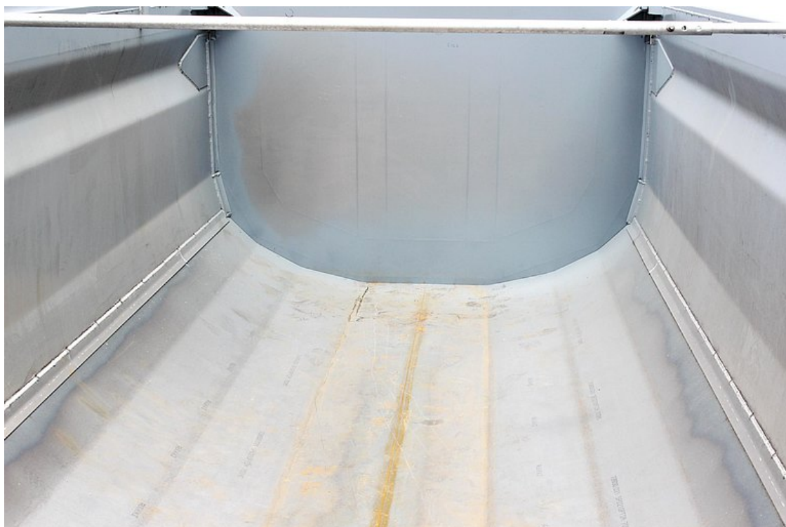
Ciągłe stalowe dno ścieralne 3 mm, z przyspawanym obramowaniem aluminiowym
