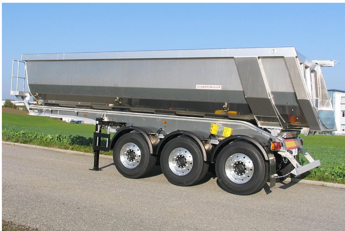
3-osiowa naczepa siodłowa wywrotka w całości aluminiowa ze skrzynią segmentową
