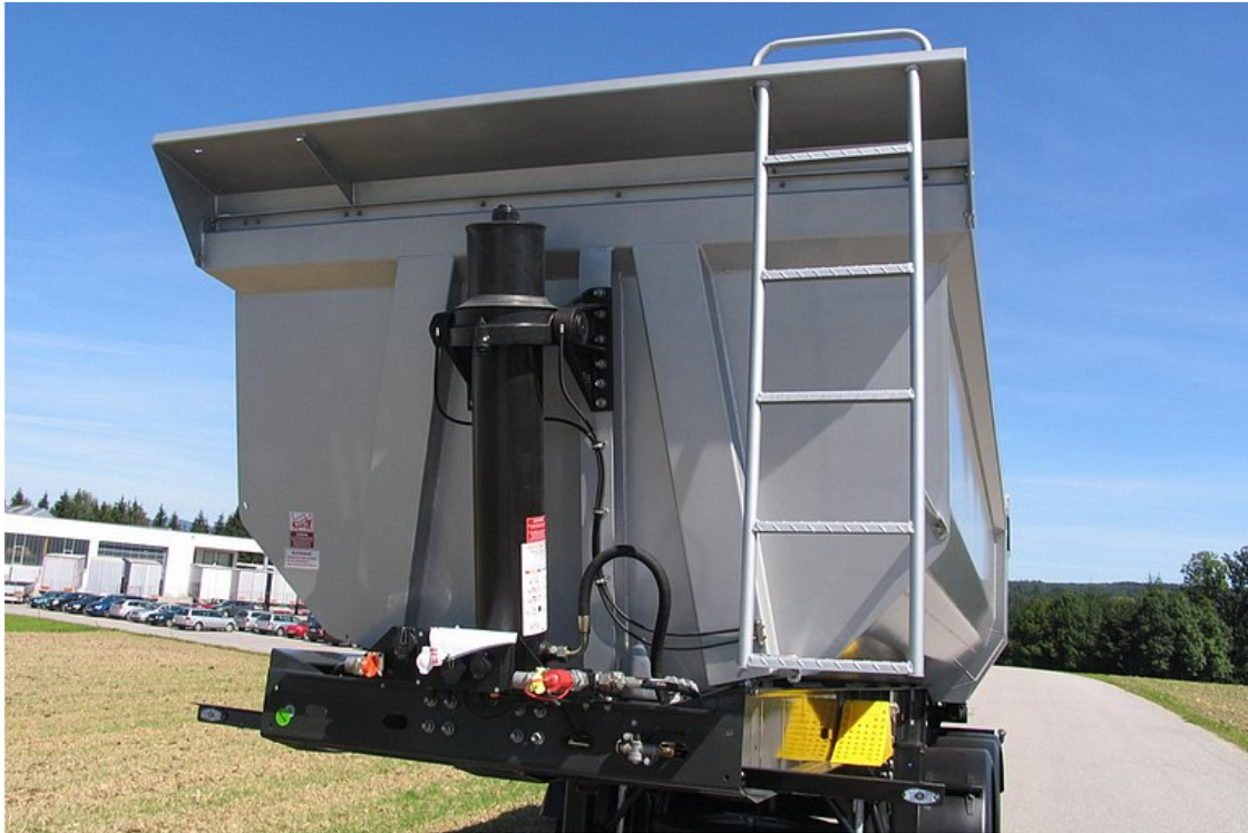
Optymalny rozkład obciążenia dzięki pochyłej ścianie przedniej
