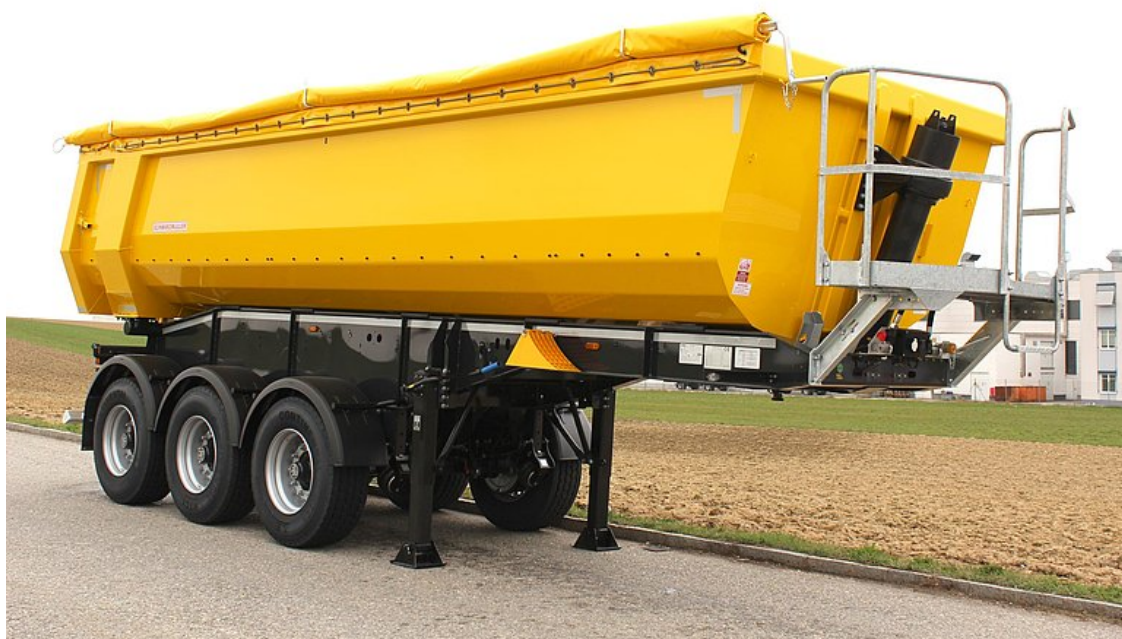
3-osiowa naczepa siodłowa wywrotka aluminiowa ze skrzynią
