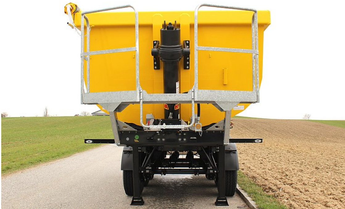
Podest stojący na ścianie przedniej do obsługi plandeki rolkowej
